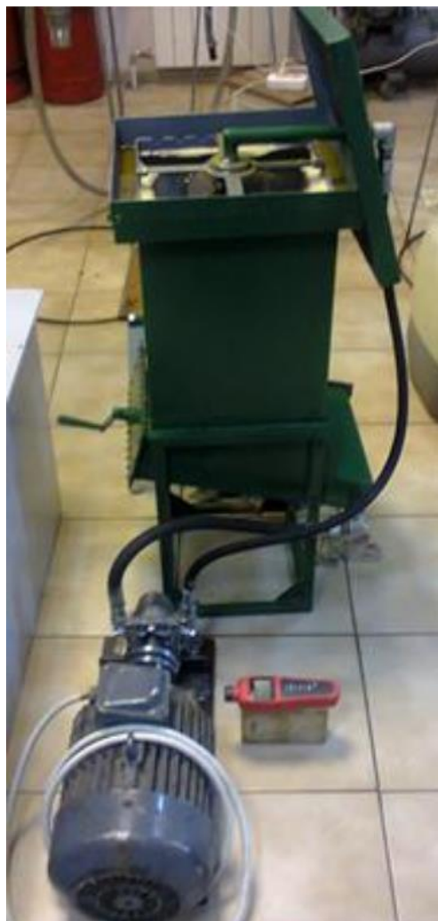
Рис.3.1. Дослідна установка безперервного виробництва біодизеля
