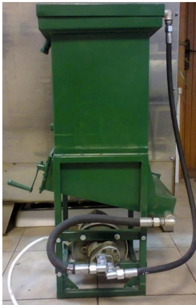
Рис.3.1. Дослідна установка безперервного виробництва біодизеля
