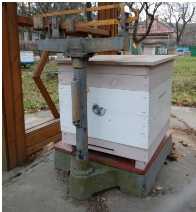
Рис. 2.7. Платформні ваги для зважування вуликів Біометричні дані оброблялися на комп'ютері за допомогою програми MS Excel 2003 з вбудованими статистичними функціями.
