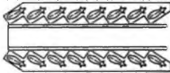
Рис. 1.3 Схема доїльної установки типу «Ялинка»
