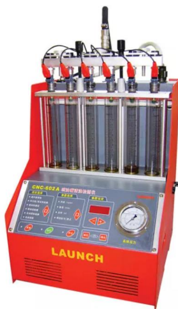
Рисунок 4 – Стенд для діагностики та очищення форсунок Launch CNC-602A
