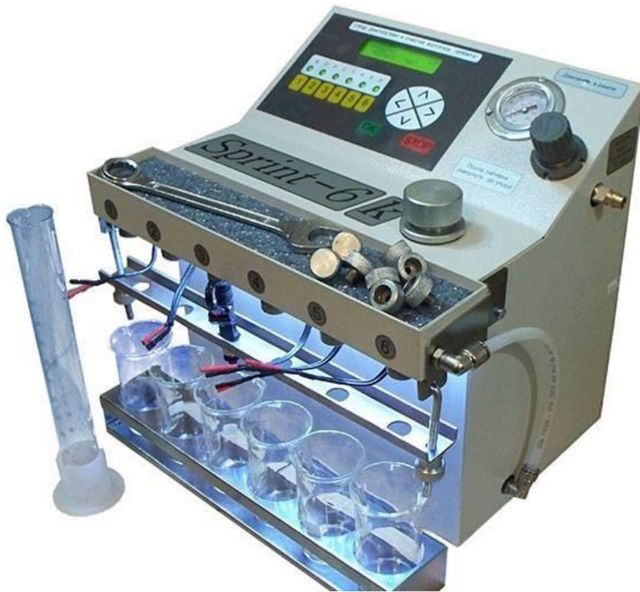
Рисунок 1 – Стенд для чищення форсунок з підсвічуванням Sprint 6
