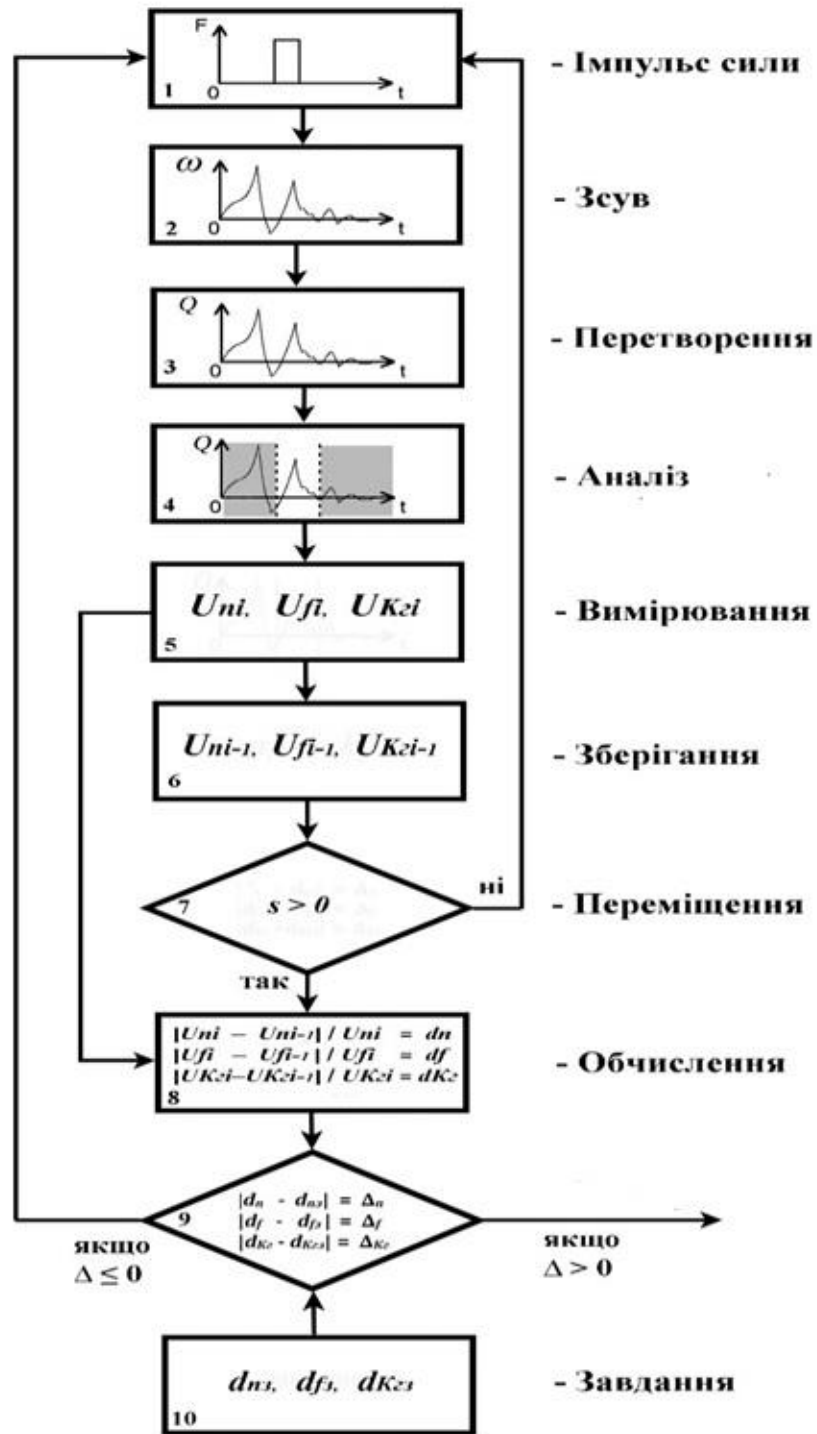
Рис. 3. Блок-схема алгоритму контролю якості фанери вдосконаленим ударним методом
