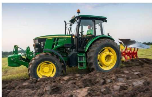
Рис. 2.4. Баластування тракторів встановленням додаткових вантажів: а - баластування трактора Т-150К; б - баластування трактора Джон Дір на оранці;
