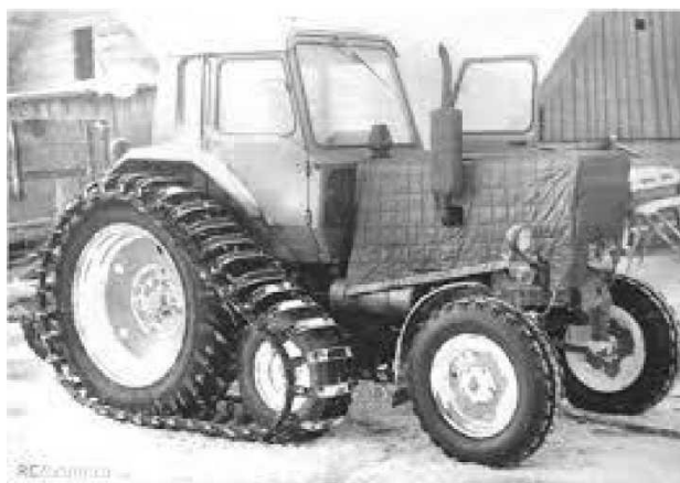
Рис. 2.6. Напівгусеничний рушій універсально-просапного трактора тягового класу 1,4 т
