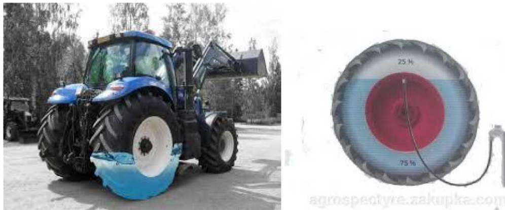
Рис. 2.5. Баластування тракторів рідиною
