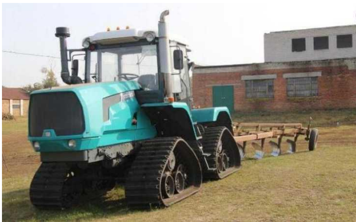
Рис. 2.6. Застосування гусеничних рушіїв на тракторах ХТЗ-280
