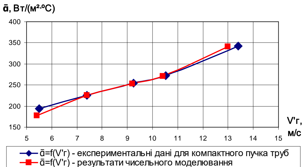
Рис. 2.17. Порівняльний графік залежностей \bar{\alpha} = f(V'_{\Gamma}) середнього коефіцієнта тепловіддачі відпрацьованих газів \bar{\alpha} від швидкості відпрацьованих газів V'_{\Gamma} для експериментальних даних компактного пучка труб і результатів чисельного моделювання
