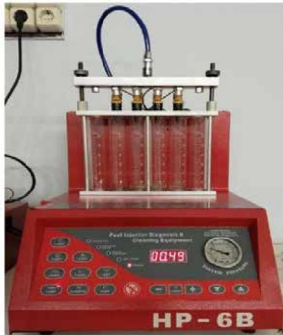
Рисунок 3.4 – Установа АЕ&Т «НР-6В» для оцінки технічного стану паливних форсунок
