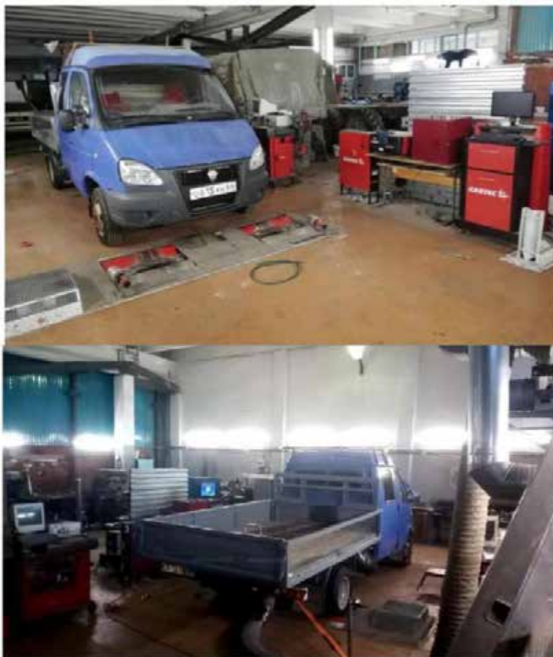
Рисунок 3.9 – Стенд з біговими барабанами та ГАЗ 27040V «Фермер»
