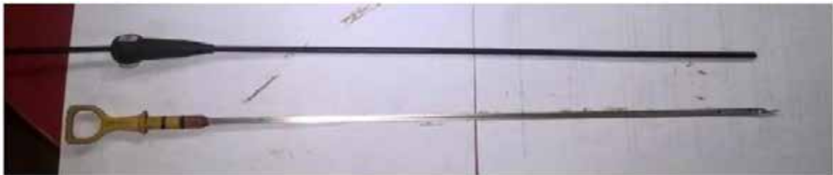
Рисунок 3.14 – Регулювання датчика температури по довжині масляного щупа
