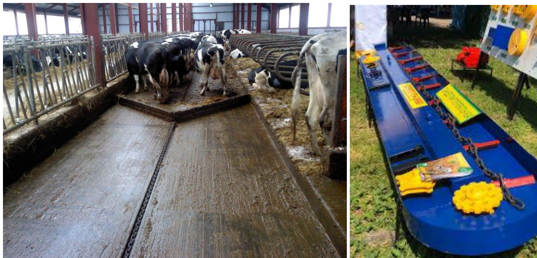
Рис. 4.3. Механізми для прибирання гною на фермах ВРХ
