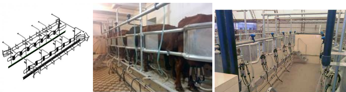
Рис. 4.2. Схема та вид каркасу доїльної зали «Ялинка» для ферми ВРХ
