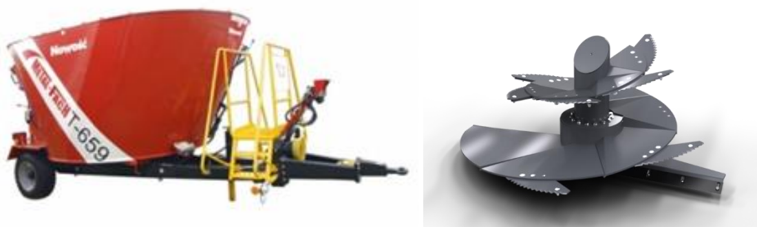
Рис. 4.8. Зовнішній вигляд мобільного кормороздавача марки BelMix T659 та змішувально-різального сталевого шнека, що входить до його конструкції
