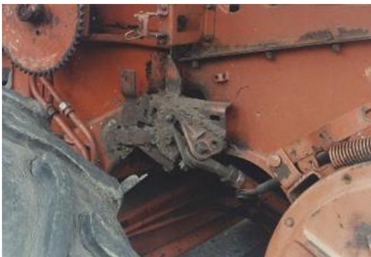
Рис. 3.3. Тріщина рами і обрив кронштейнів з правого боку комбайна
