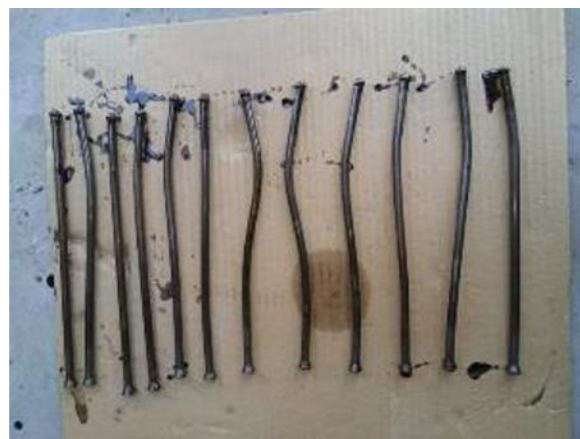
Рис. 3.9. Експлуатаційна відмова погнуті штанги двигуна
