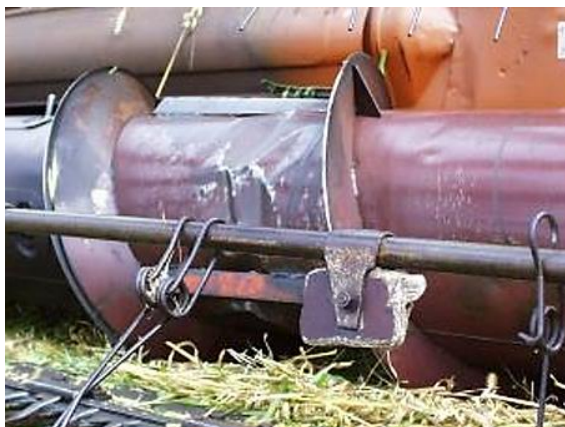
Рис. 3.7. Попадання сторонніх предметів під шнек жатки.
