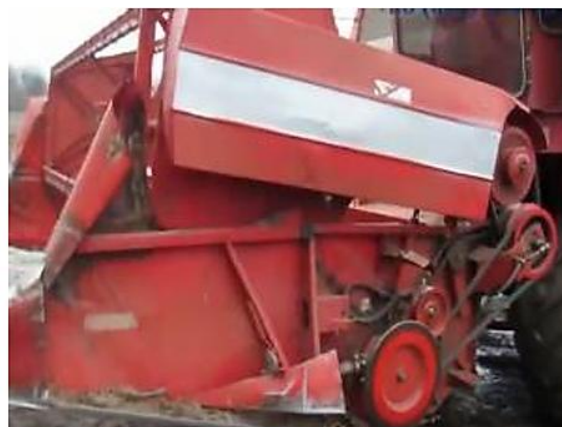
Рис. 3.7. Попадання сторонніх предметів під шнек жатки.
