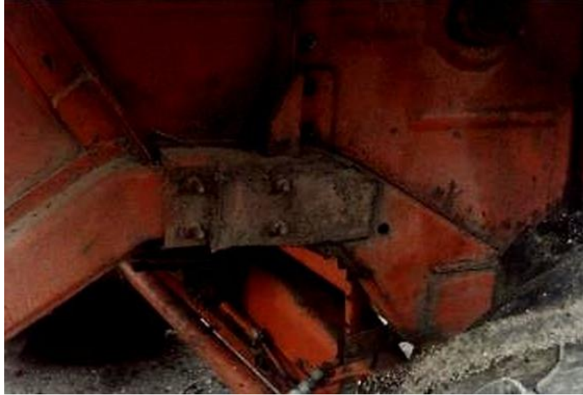
Рис. 3.1. Тріщина рами комбайна і ремонт в господарських умовах
