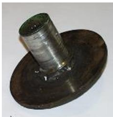
Рис. 3.6. Технологічний недолік - а - в шліцьовій муфті відсутній розріз і отвір для стяжного болта. б - обрив фланця запобіжної муфти по
