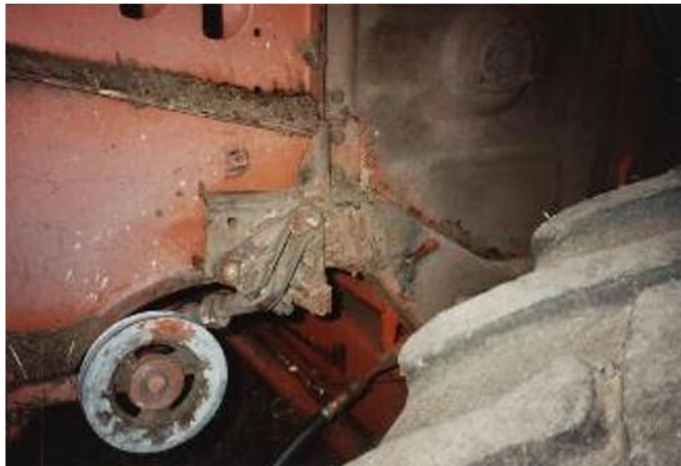
Рис. 3.2. Тріщина рами і обрив кронштейнів з лівого боку комбайна
