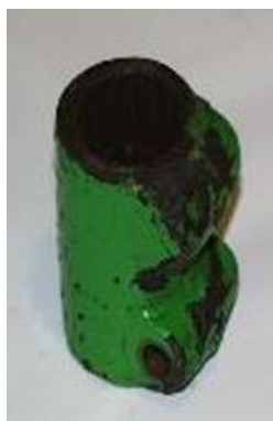
Рис. 3.6. Технологічний недолік - а - в шліцьовій муфті відсутній розріз і отвір для стяжного болта. б - обрив фланця запобіжної муфти по
