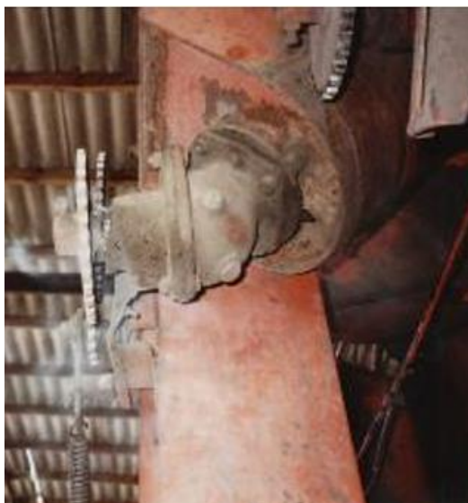
Рис. 3.4. Типовий приклад конструктивної відмови - кінематична неточність ланцюгових передач, яка є причиною прискороного зношення і злітання ланцюгів.
