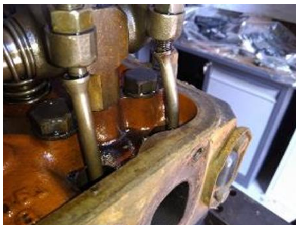
Рис. 3.9. Експлуатаційна відмова погнуті штанги двигуна
