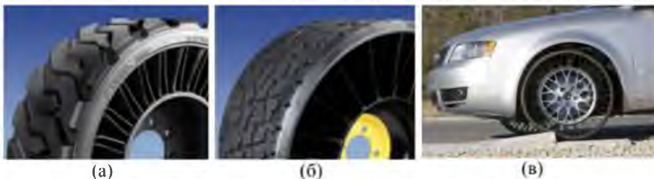
Рисунок 1.4 - Колеса Michelin X Tweel для навантажувачів (а), газонокосарок (б) та автомобілів (в).
