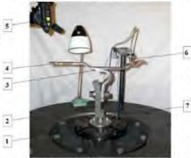
Рисунок 3.18 - Загальний вид електродинамічного вібраційного стенду в зборі з випробуваним зразком
