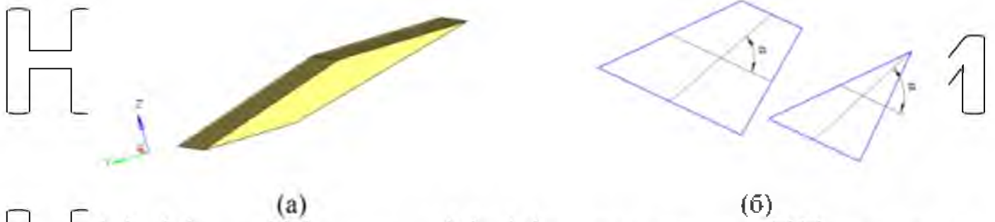
Рисунок 2.3 - Приклад спотворення за критерієм «нахил елемента» (а) та кут, що його характеризує (б)
