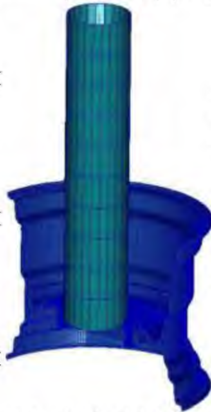
Рисунок 3.16 - Розрахункова схема для аналізу міцності втоми колеса
