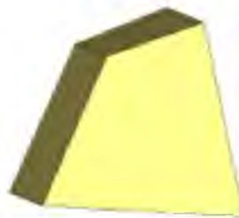
Рисунок 2.4 - Зовнішній вигляд елемента зі значенням якобіана < 0,5
