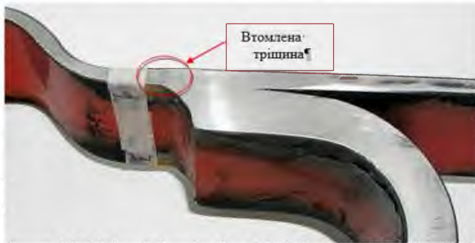
Рисунок 3.21 - Втомна тріщина у випробуваному зразку
