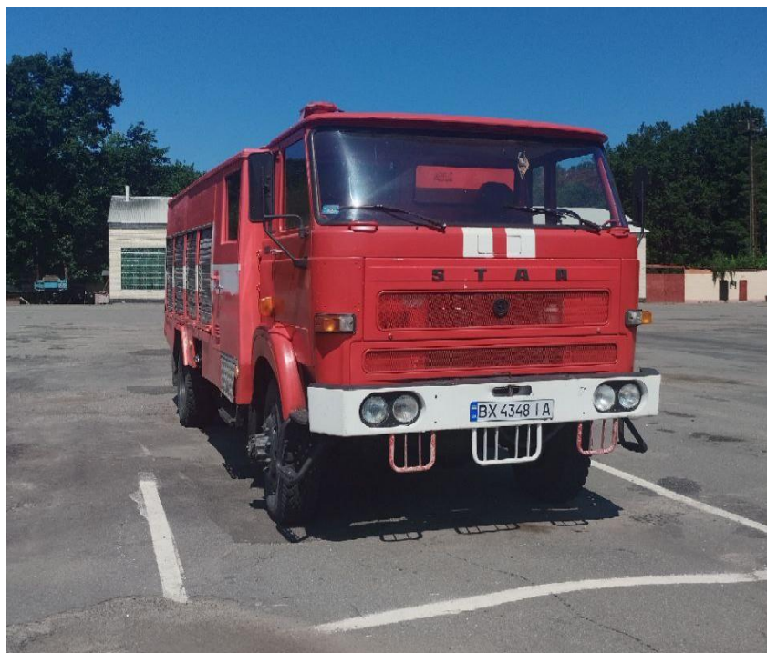
Рис 4.10. Пожежний автомобіль на базі Star 244
