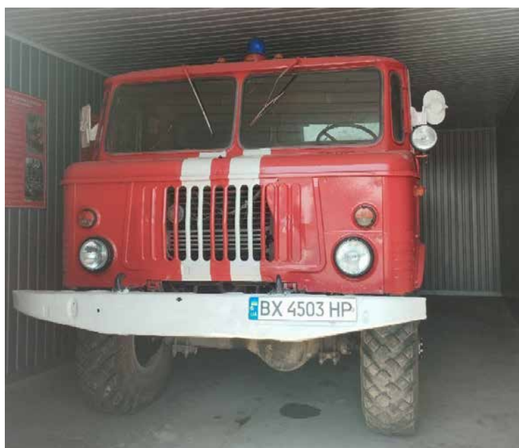
Рис 4.9. пожежний автомобіль на базі ГАЗ 66
