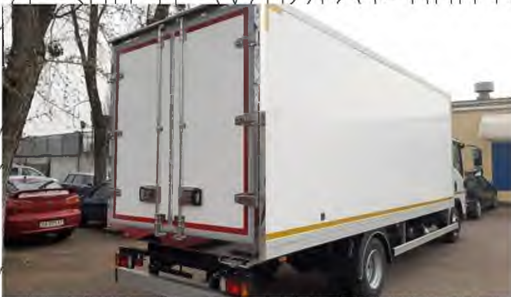
Рис. 3.4. Ізотермічний фургон на базі вантажного авто Isuzu NQR 90
