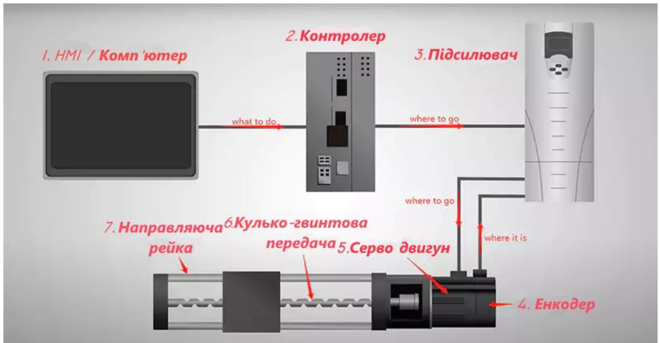
Рис. 1.10. Основні елементи керування верстата з ЧПК
