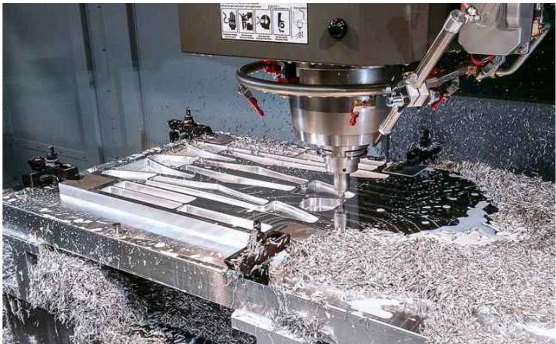
Рис. 1.11. Процес фрезерування на сучасному ЧПК верстаті
