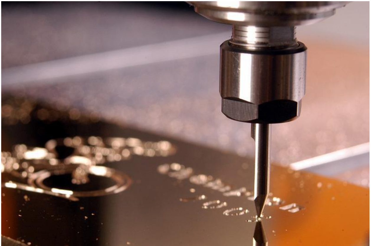
Рис. 1.12. Процес гравіювання на сучасному ЧПК верстаті
