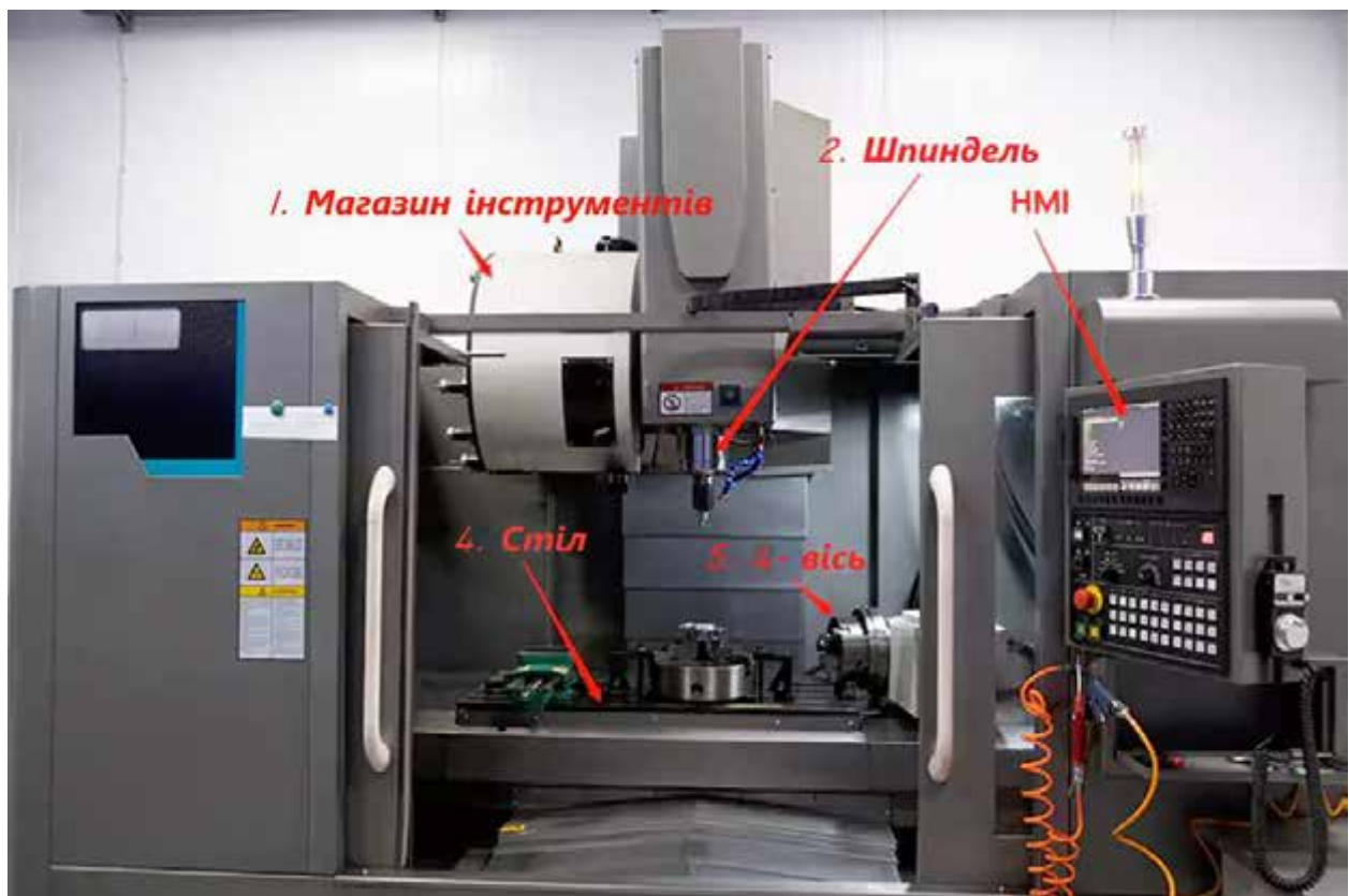
Рис. 1.9. Конструктивні елементи сучасних фрезерних верстатів
