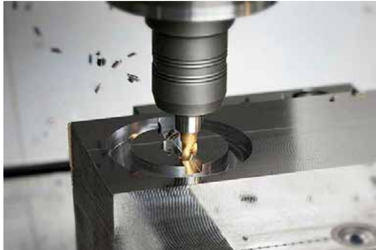
Рис. 1.13. Процес фрезерування пазів
