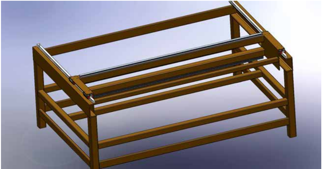
Рис. 2.9. Вигляд 3д моделі рухомого порталу на станині верстата
