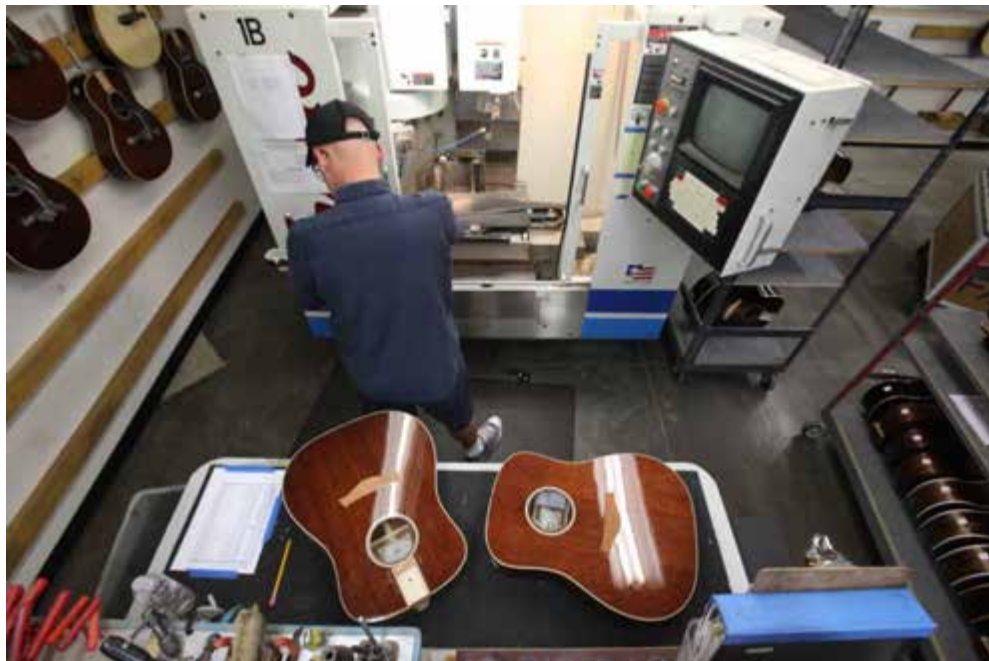
Рис. 1.20. Використання фрезерного верстата Наас для різьблення по дереву в гітарах.
