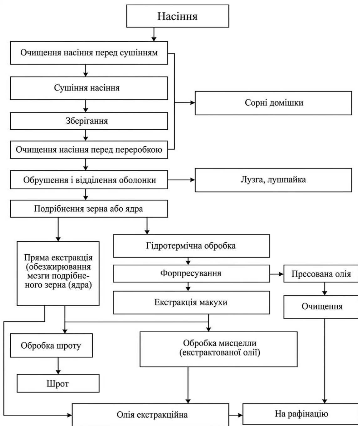
Рис. 1.1 – Принципова технологічна схема виробництва соняшникової олії
