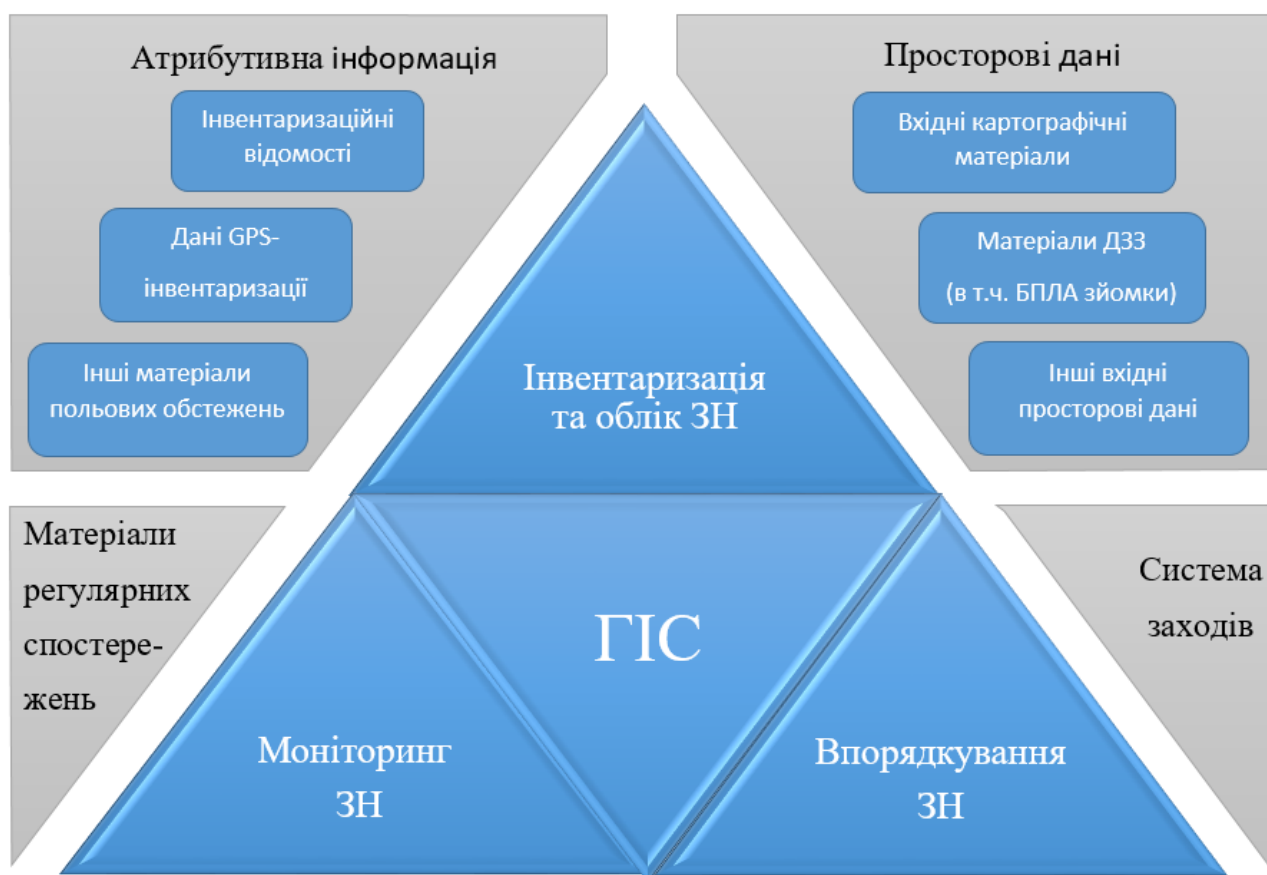
Рис. 2. Схема організації інформаційних потоків у системі впорядкування зелених насаджень за допомогою геоінформаційних систем (ЗН – зелені насадження, БПЛА – безпілотний літальний апарат)
