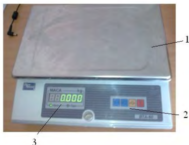
Рис. 3.4. Електронні лабораторні технічні ваги VTA-60:
