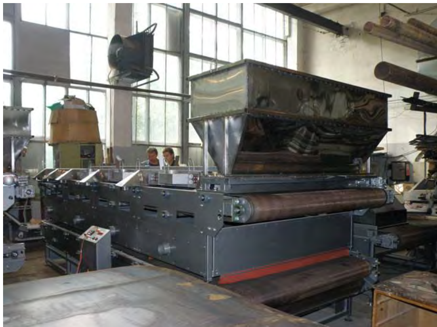
Рис. 6.7. Інфрачервона конвеєрна сушарка УТЗ-4 «М-500»
