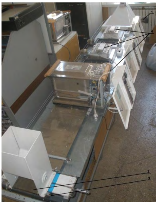
Рис. 3.6. Експериментальна конвеєрна установка для ГЧ-сушіння зерна
