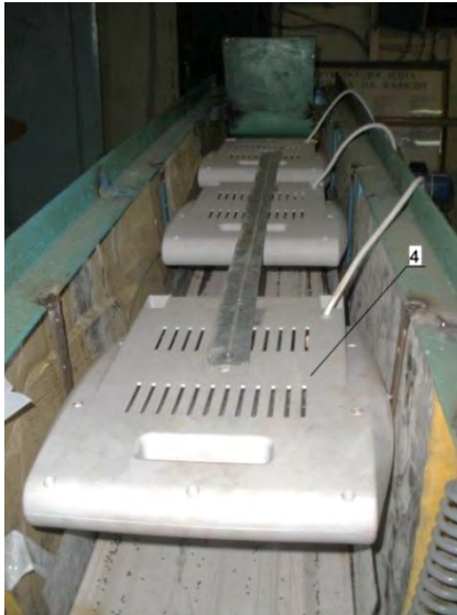
Рис. 6.21. Зовнішній вигляд експериментально-промислової моделі інфрачервоної віброхвильової сушарки
