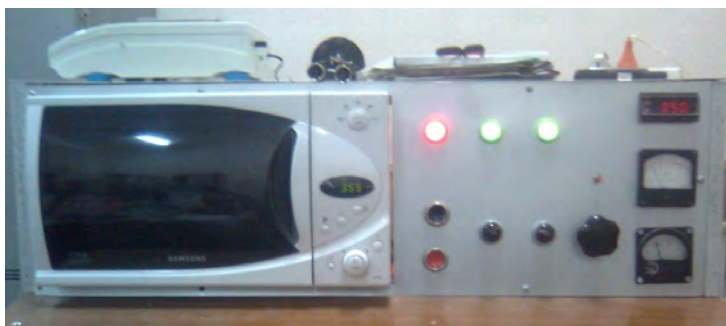
Рис. 3.3. Експериментальна установка для сушіння з використанням інфрачервоного опромінювача.
