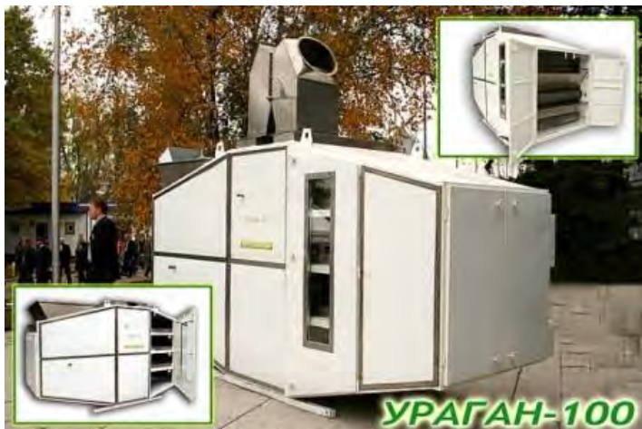
Рис. 6.6. Конвеєрні інфрачервоні сушарки «Ураган»-100
