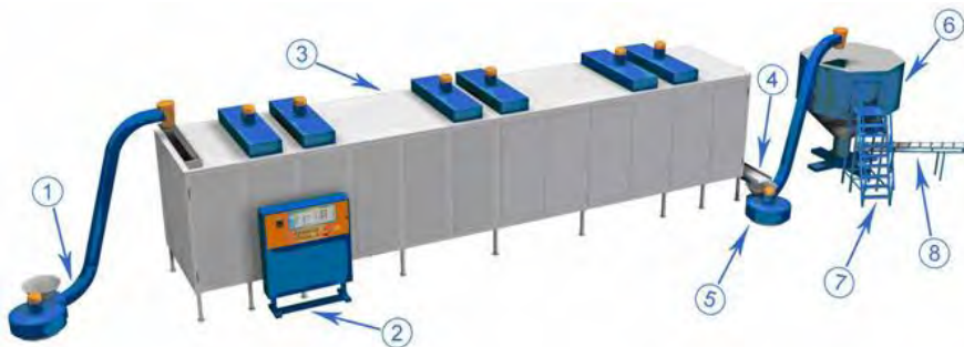
Рис. 6.8. Технологічна схема універсальної конвеєрної інфрачервоної сушарки:
