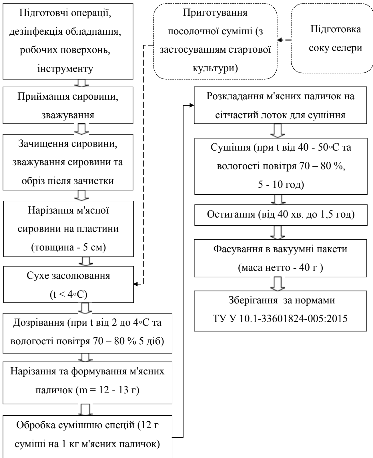
Рисунок 4.24. Вдосконалена технологічна схема виробництва сиров'ялених м'ясних снєків
