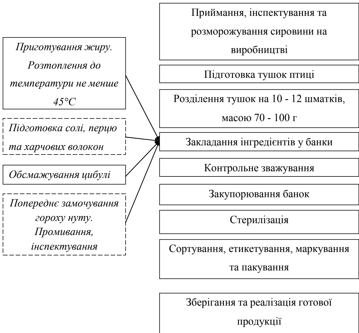
Рисунок 3.3. Технологічна схема виробництва м'ясо-рослинних консервів з горохом нутом та харчовими волокнами
