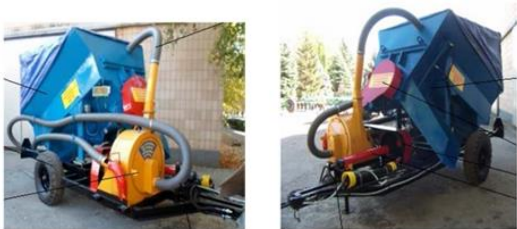
Рис. 1.7 - Мобільний комбикормовий завод АКМ-3М
