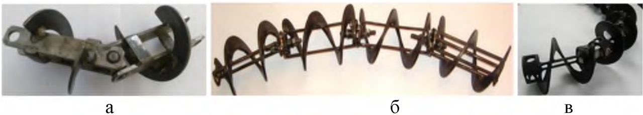
Рис. 1. Загальний вигляд спарених шарнірних секцій гвинтового робочого органу з плоскими пластинами (а) з прутковими з'єднаннями із торцевими кульковими зачепленнями (б) та радіальними пальцевими зачепленнями (в).
