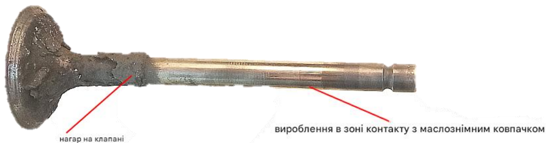
Рис. 1.2. Зображення прогорілого клапана
