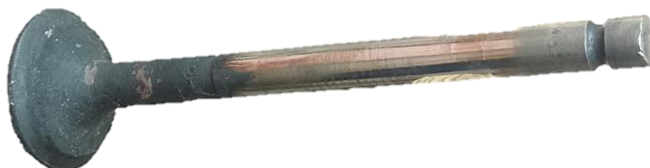
Рис.1.4. Втомних тріщини на шийці клапана ДВЗ
