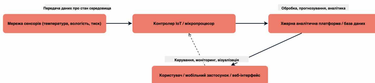
Рис. 1.1 – Структура предметної області системи автоматизації опалення на основі технологій інтернету речей
