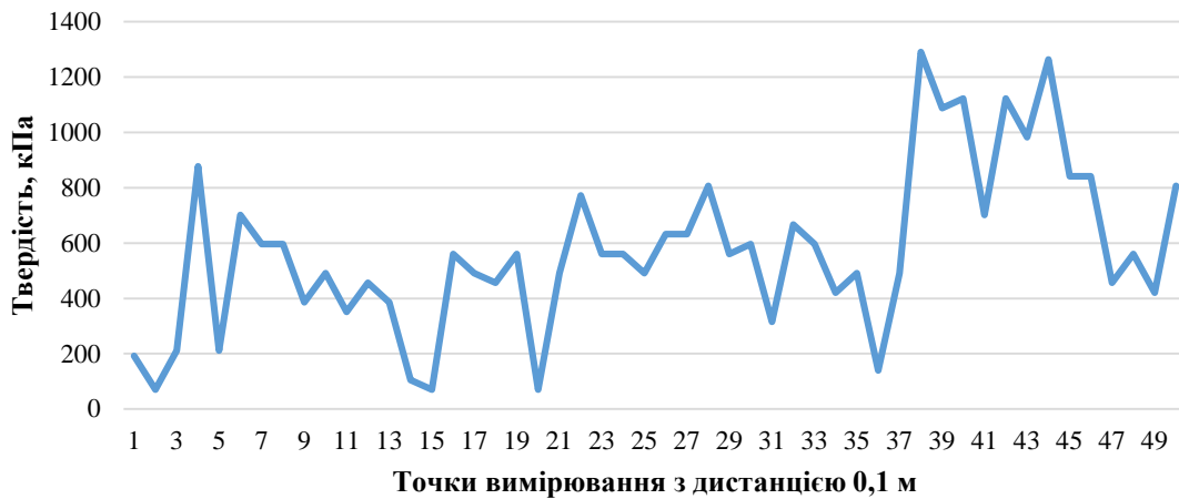
Рис. 12. Зміна твердості ґрунту на глибині 0,05 м, кПа
