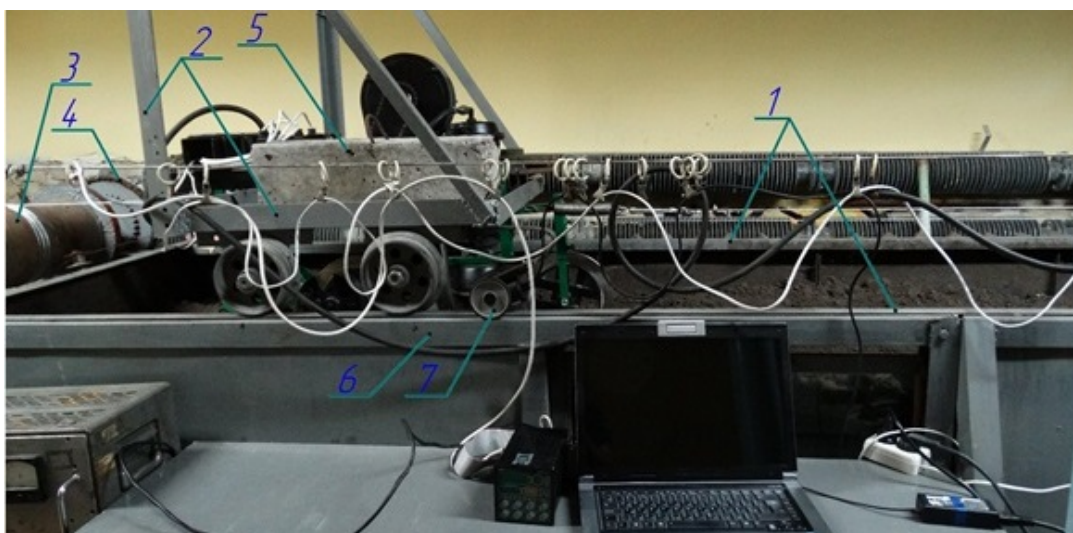
Рис. 10. Загальний вигляд експериментальної лабораторної установки: 1 – напрямні рейки ґрунтового каналу; 2 – візок із двофазною сошникомовою системою; 3 – тяговий барабан; 4 – ланцюгова передача привода тягового барабана; 5 – балансір-довантажувач; 6 – рейка реєстратора пройденого шляху і швидкості руху; 7 – датчик n-coder
