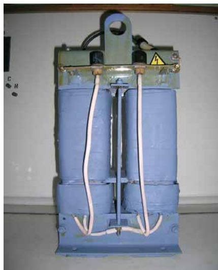
Рис. 4.7. Високовольтний трансформатор сухий ОСВ-1,5 220/15000
