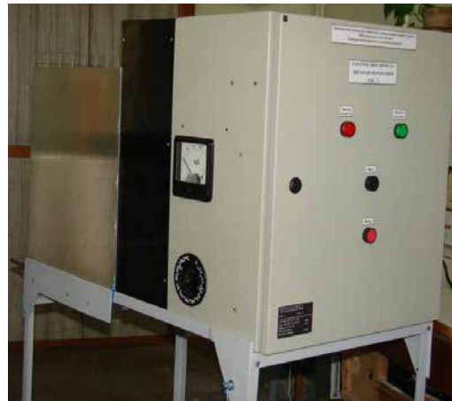
Рис. 4.6. Зовнішній вигляд установки для обробки зернових в сильному електричному полі
