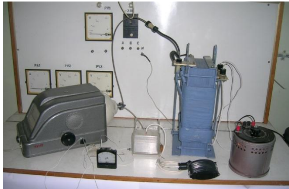
Рис. 3.10. Зовнішній вигляд установки дослідження концентрації озону в зерновій суміші
