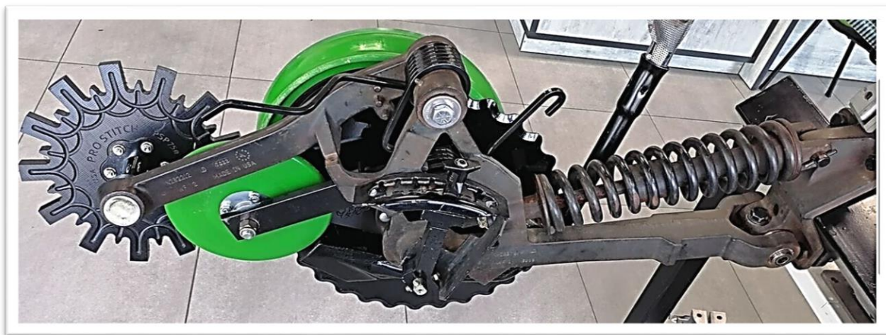
Рис. 2.2. Механізм контролю глибини висівної секції пневматичної сівалки.
