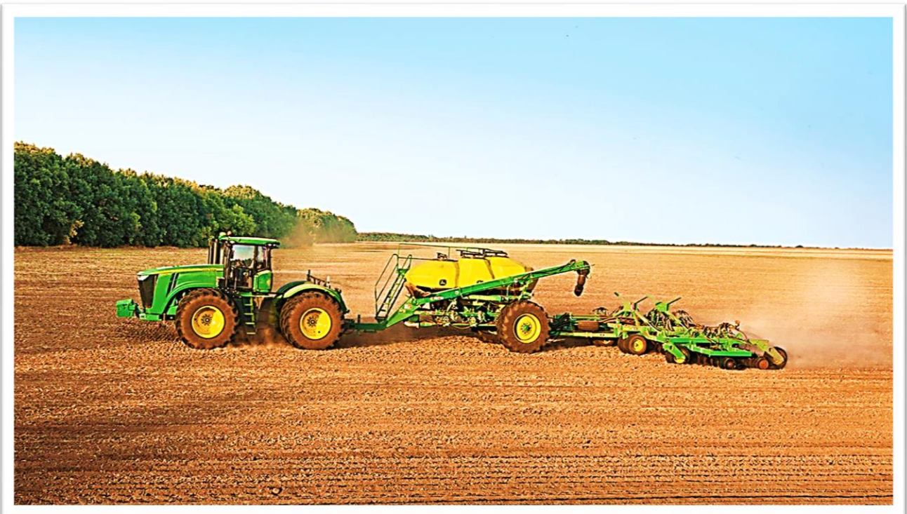
Рис. 2.1. Пневматична зернова сівалка точного висіву John Deere 1890.
