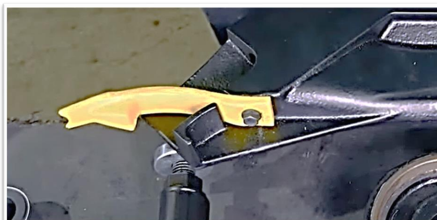
Рис. 2.16. Заспокоювач насіння виготовлений за технологією 3D друку.
