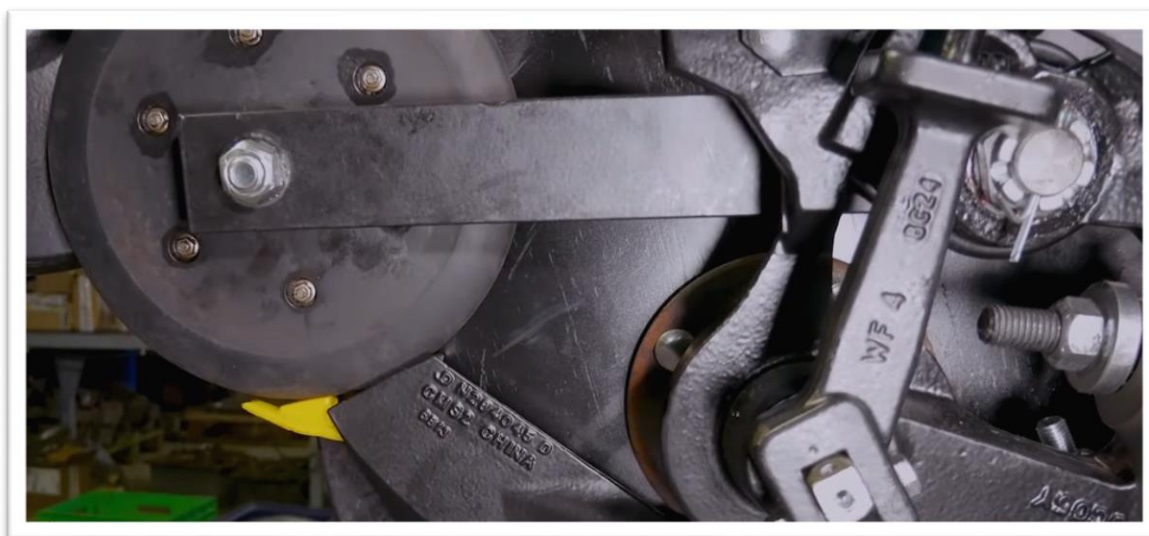
Рис. 2.4. Висівний башмак з нейлоновим насіннєвим відбивачем.
