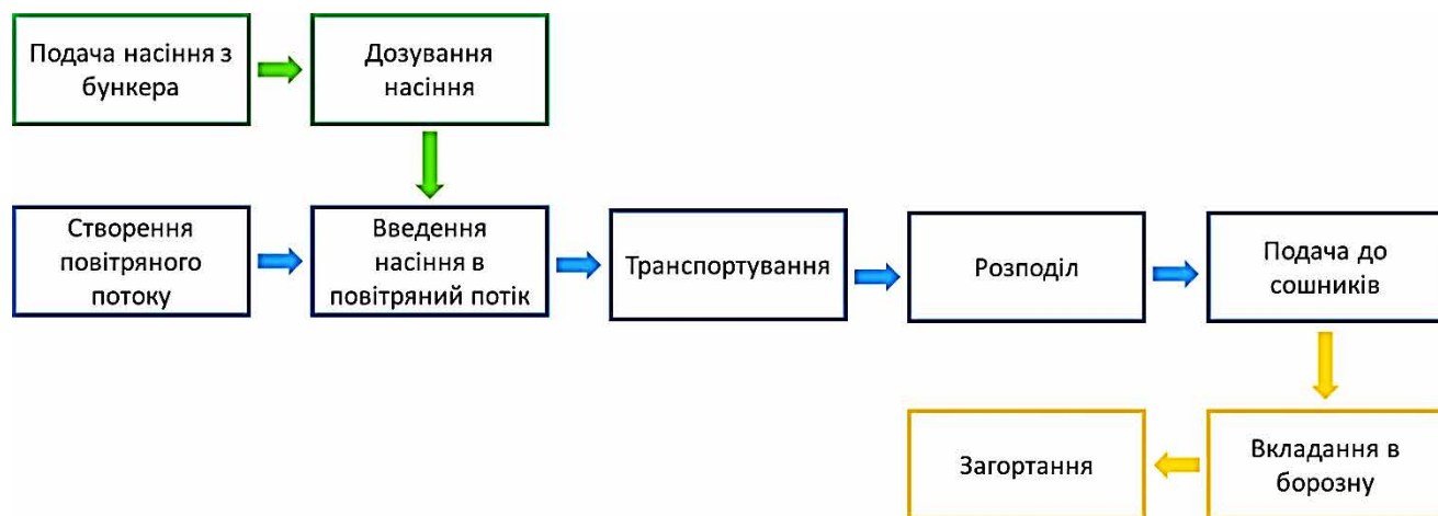
Рис. 1.9. Схема технологічного процесу сівалки з пневматичною системою висіву.
