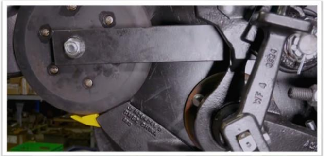
Висівний башмак з нейлоновим заспокоювачем насіння
