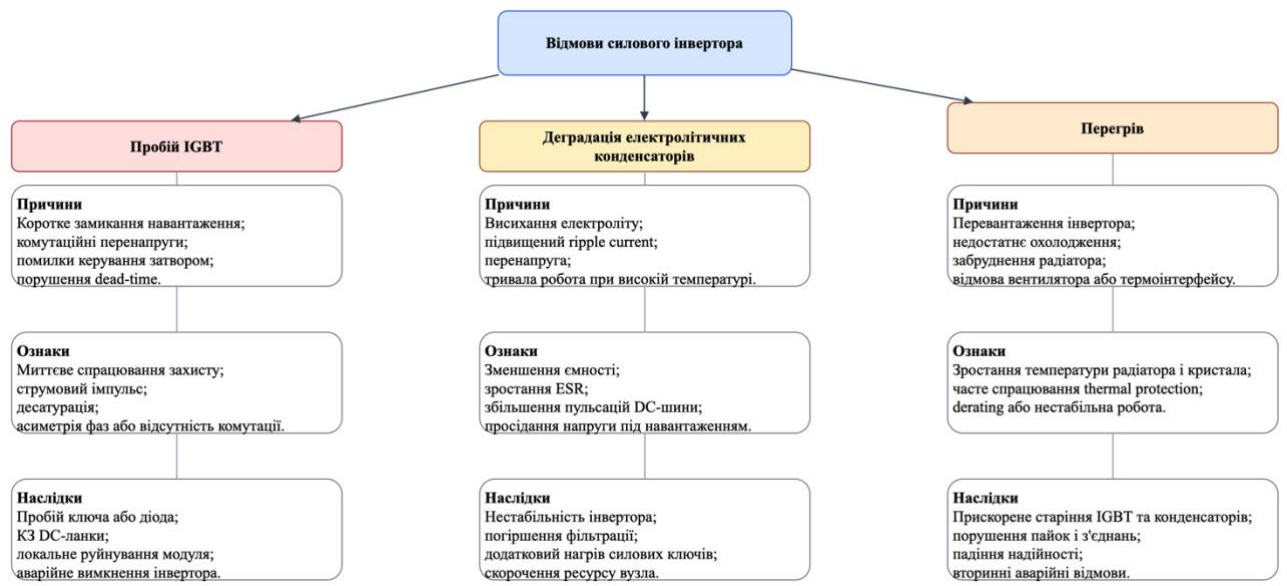
Рис. 1.2. Класифікація основних видів відмов силового інвертора
