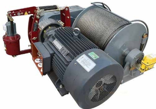
Рисунок 1.9 – Підйомний механізм 25PC13
