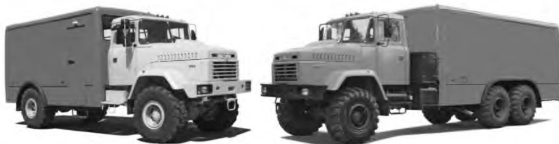
Рис. 4. Кузови-фургони на базі автомобілів КрАЗ-5233 HE і КрАЗ- 63221.
