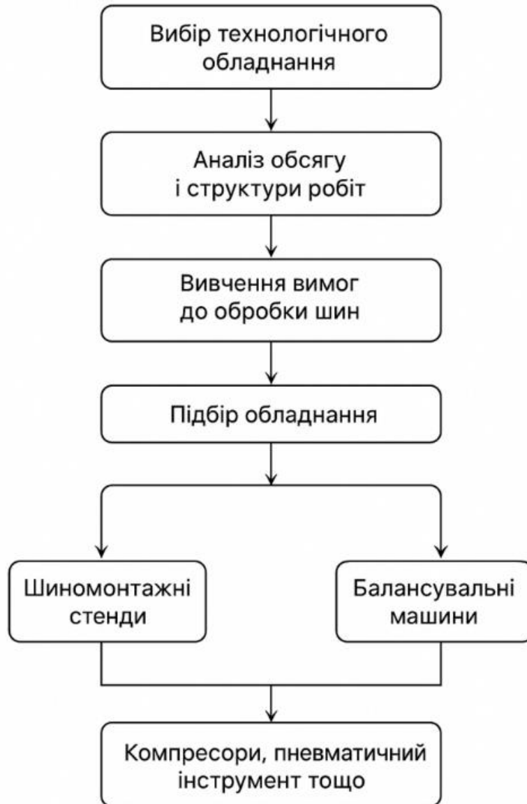
Рис. 2.4 Схема підбору технологічного обладнання на шиномонтажній дільниці
