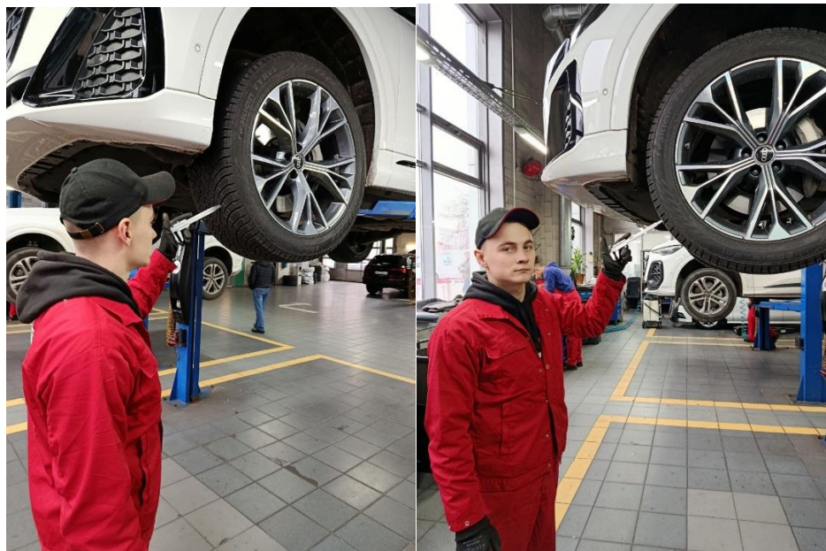
Рис. 3.3 Вимірювання висоти протектора
