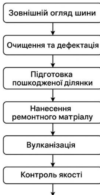
Рис. 2.3 Схема технологічного процесу ремонту шин
