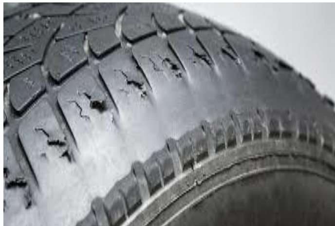
Рис. 1.3 Нерівномірний знос протектора
