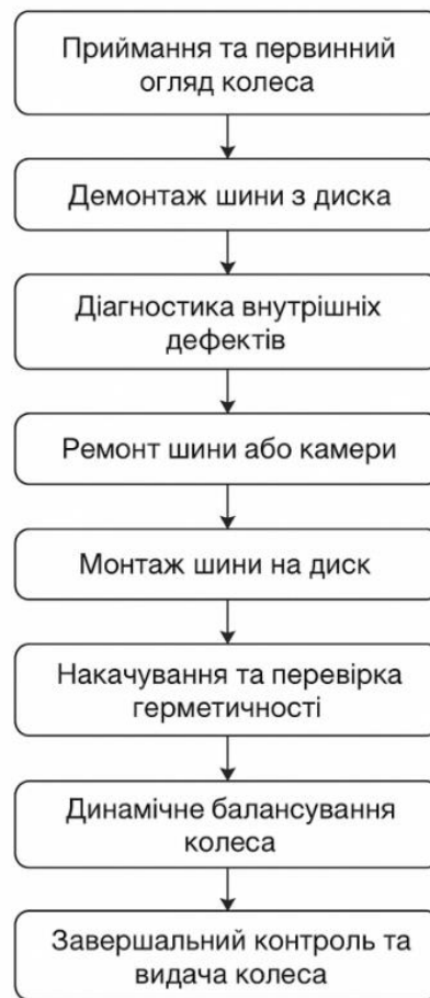
Рис. 2.12 Схема технологічного процесу робіт у шиномонтажній дільниці
