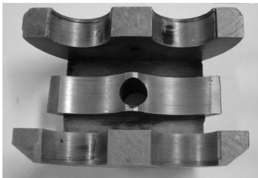
Рис. 4.2. Зовнішній вид зносу підтискної обойми.
