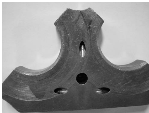
Рис. 4.1. Зовнішній вид зносу торцевої поверхні платика
