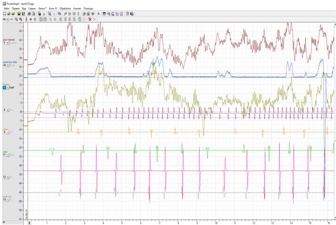
Рисунок 3.4 – Фрагмент експериментальних осцилограм силових і кінематичних параметрів трактора, що реєструються вимірювальні параметри трактора Zetor
