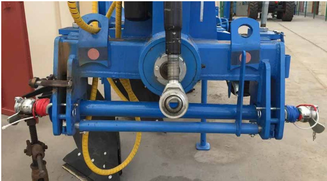
Рисунок 3.5 – Розміщення тензометричних ланок у конструкції ґрунтообробного знаряддя
