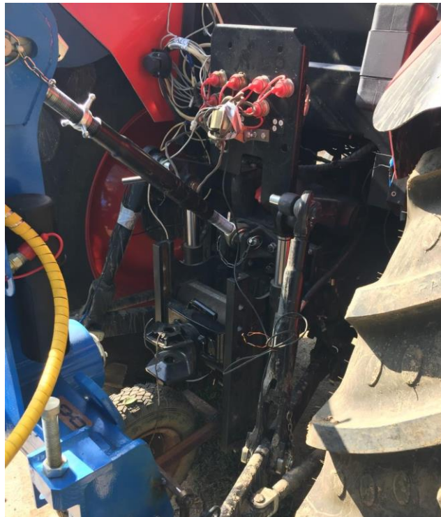
Рисунок 3.6 – Загальний вид розміщення тензометричних ланок, які фіксують тяговий опір знаряддя.
