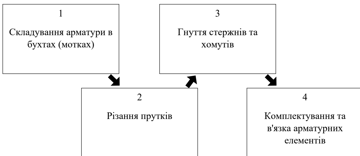
Рис 3.1 – Принципова функціональна схема виготовлення арматурних виробів на будівельному майданчику
