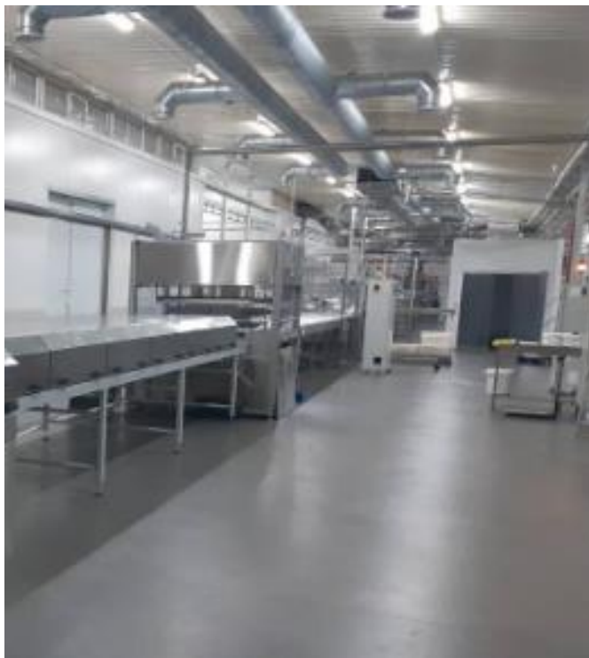
Рис. 2.6. Холодильні тунелі [фото автора]
