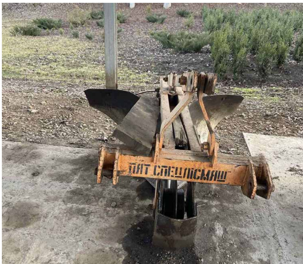
Рис. 4.10. Плуг ПКЛ-70, що використовується для оборювання пожеж і створення мінералізованих смуг (фото автора)
