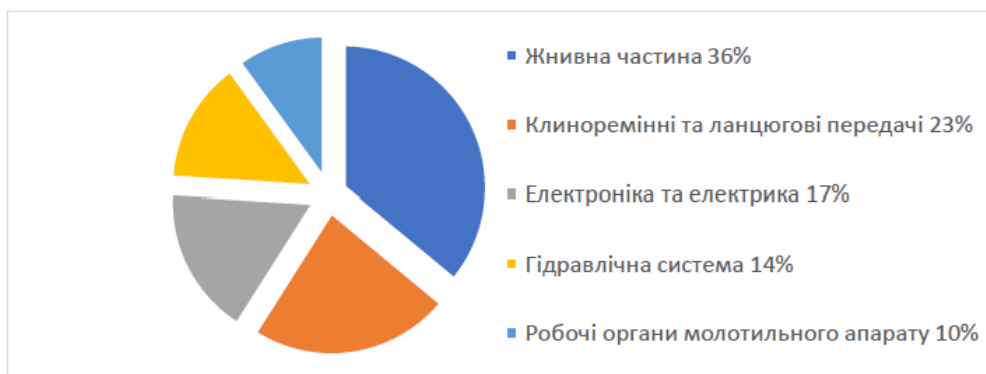
Рис. 1.1 - Діаграма несправностей зернозбиральних комбайнів CLAAS0 Найбільша кількість відмов припадає на жнивну частину (36%), також значна
