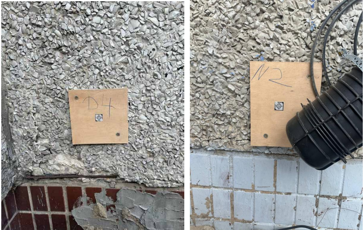
Рисунок 11 - Вигляд закріплених мережі деформаційних марок на фасаді будівлі ліцею
