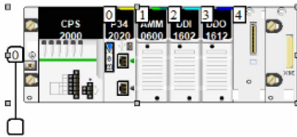
Рис. 5.1. Компонування модулів ПЛК Modicon M340 (Schneider Electric)
