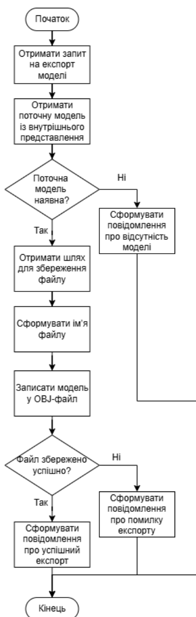
Рис. 24 Блок-схема алгоритму експорту обробленої тривимірної моделі
