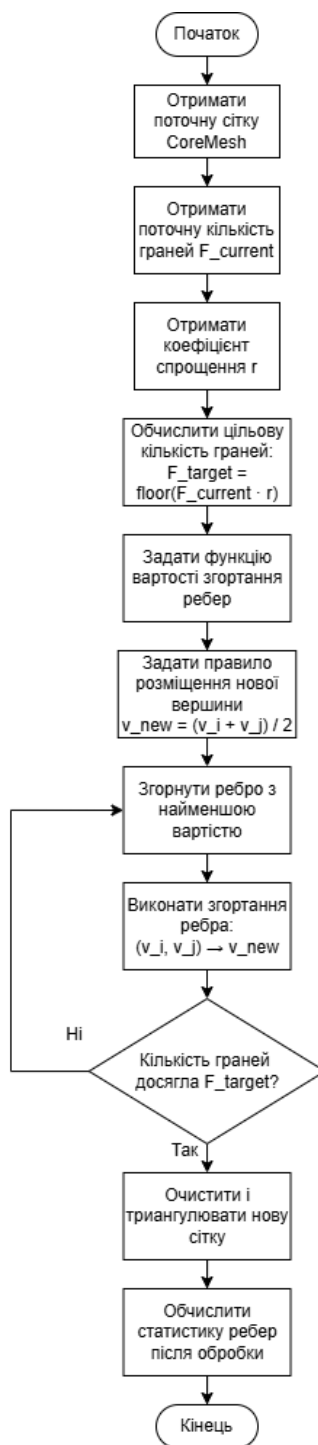
Рис. 27 Блок-схема алгоритму спрощення топологічної сітки Decimate
