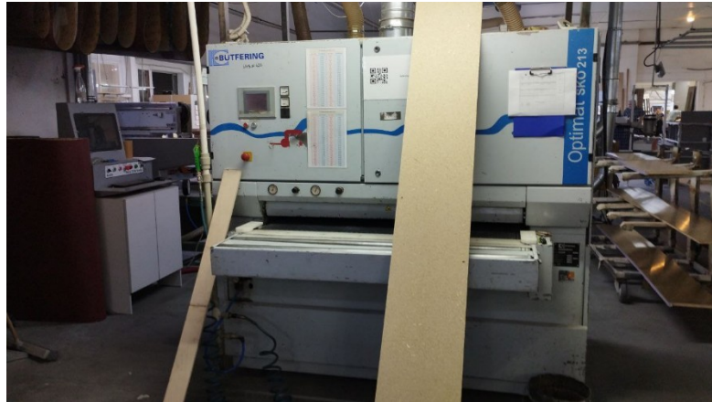
Рис. 4.4. Калібрувально-шліфувальний центр BUTFERING[40]
