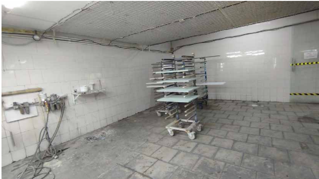
Рис. 4.14. Нерівномірне освітлення малярної камери
