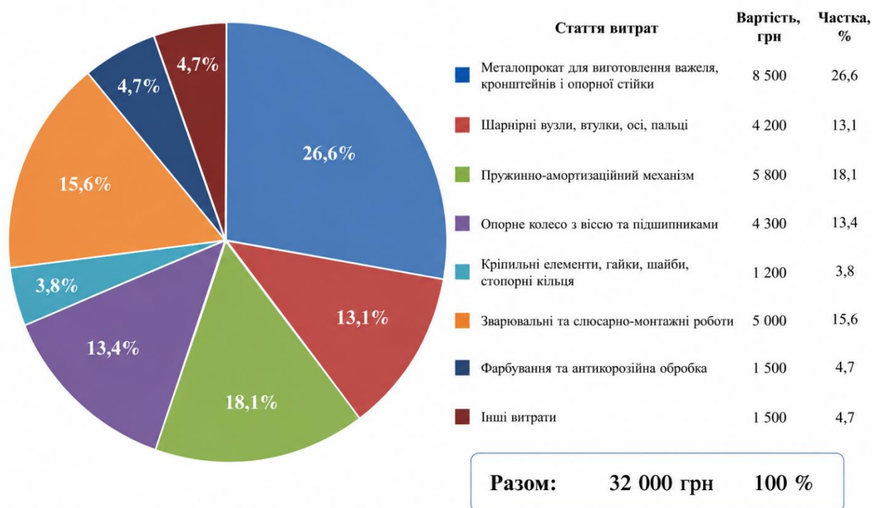
Рисунок 4.3 – Структура витрат на виготовлення механічного довантажувача
