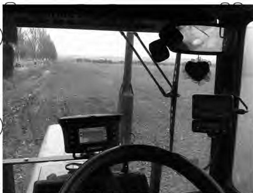
Рис. 3.9. Забезпечення стикового перекриття за допомогою навігатора.
