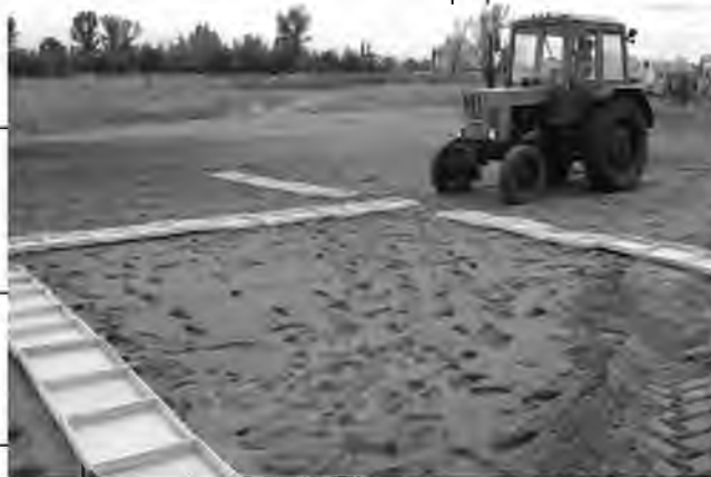
Рис. 3.11. Розміщення лотків по полю для визначення рівномірності внесення добрива.
