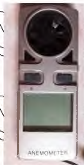
Рис. 3.4. Використаний у дослідях анемометр DF318.
