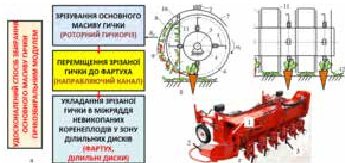
Рис. 2. Блок-схема (а) удосконаленого способу та конструктивна схема (б – вигляд збоку; в – вигляд ззаду) удосконаленого модуля збирання гички: 1 – коренеплід з гичкою; 2 – рама; 3 – роторний гичкоріз; 4 – барабан; 5 – ніж; 6 – ділильний диск; 7 – кожух; 8 – направляючий канал; 9, 10 – вхідний і вихідний отвір; 11 – фартух; 12 – укладена у міжряддя подрібнена гичка; г – загальний вигляд існуючого модуля збирання гички: 1 – шнековий конвеєр; 2 – роторний гичкометальник; 3 – обрізник залишків гички
