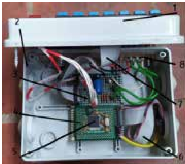
Рис. 4. Пристрій мікроконтролерного блока керування: 1 – панель керування; 2 – корпус; 3 – монтажна плата аналогової частини схеми; 4 – монтажна плата цифрової частини схеми; 5 – мікроконтролер MSP430; 6 – CAN-шина роз'єму для налагодження; 7 – CAN-шина панелі керування; 8 – роз'єм для датчиків і виконавчих пристроїв.
