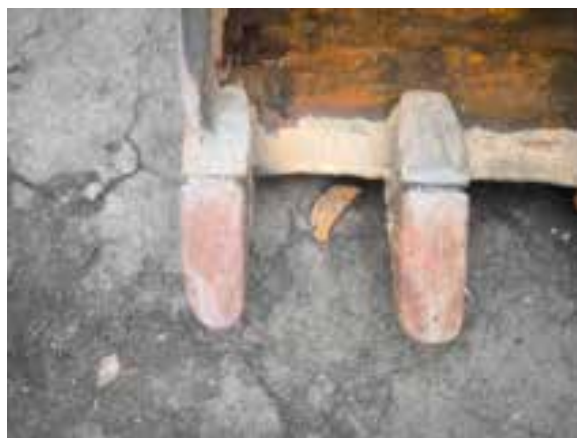
Рис. 3. Корозійні процеси на поверхні елемента A_1 .
