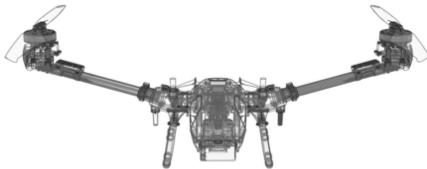
Рис. 1. Двороторна структура агродрона з автоматом перекосу
