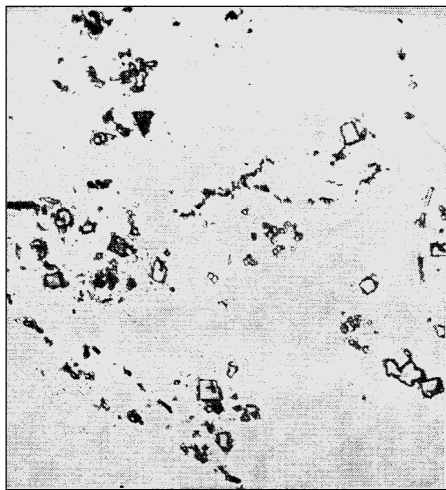
Рис. 11.137. Неметалеві включення в сталі X18H9. \times 200
