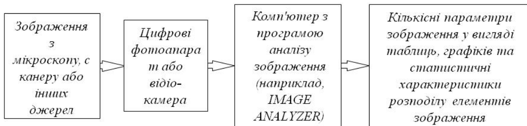
Рис. 11.136. Принципова схема комп'ютерного аналізу зображення
