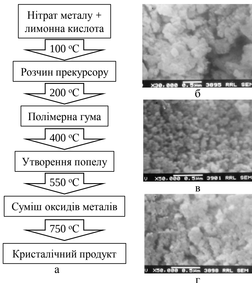
Рис. 18.208. Схема синтезу (а), форма та розміри наночастинок \text{Ba}_2\text{CeSnO}_6 (б), \text{Ba}_2\text{LaSnO}_{5.5} (в) \text{Ba}_2\text{NdSnO}_{5.5} (г), отриманих методом піролізу полімерів
