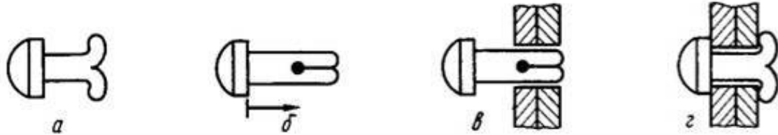
Рис. 10.121. Принцип дії стопора з ефектом пам'яті форми.
