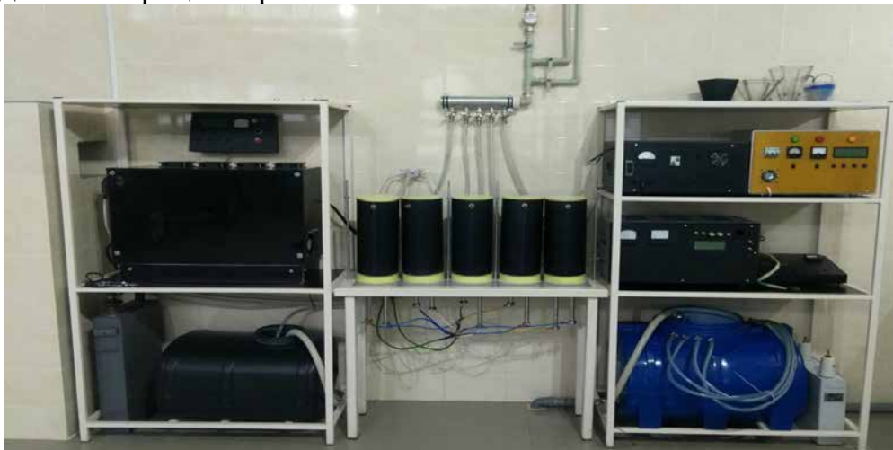
Рис. 18.225. Вигляд комплексу електроіскрового диспергування (а) та зображення локальних іскрових розрядів між гранулами (б): 1-блок керування параметрами розряду; 2-розрядна камера; 3-генератор розрядних імпульсів
