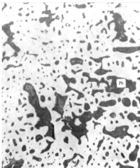
Рис. 9.89. Мікроструктура бронзи марки Бр.С30. \times 200
