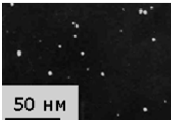
Рис. 18.215. Схема накопичувальної прокатки (а) і структура Ni-Fe-Co-Si-B сплаву (б) після гартування з рідкого стану і прокатки:
