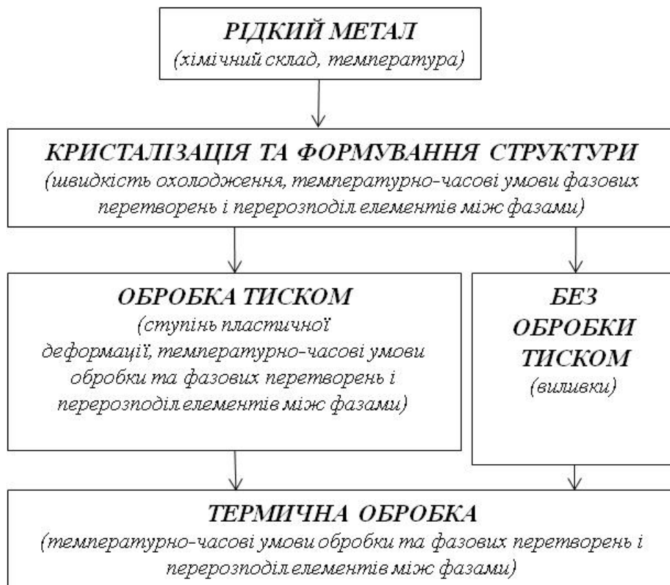
Рис. 11.134. Основні етапи формування структури і властивостей заготовок з якісних і високоякісних металів і сплавів
