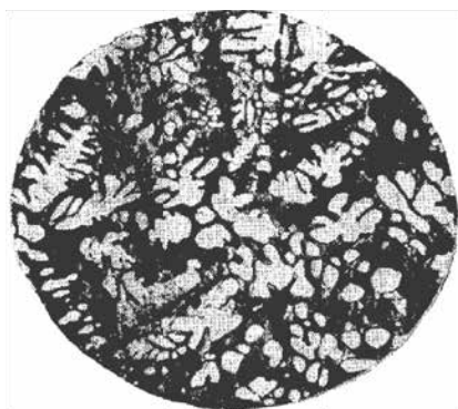
Рис. 9.100. Мікроструктура литого сплаву з 96% Zn і 4% Al: дендрити \beta -фази (світлі); \alpha_2 – фаза, що частково розпалась (темний фон). \times 100 .
