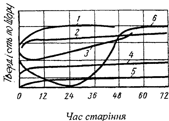
Рис. 12.147. Зміна твердості гум при термічному старінні (200 °C): 1- хлоропреновий каучук; 2,3- нітрильний каучук, 4- бутилкаучук; 5-силиконовий каучук; 6- натуральний каучук
