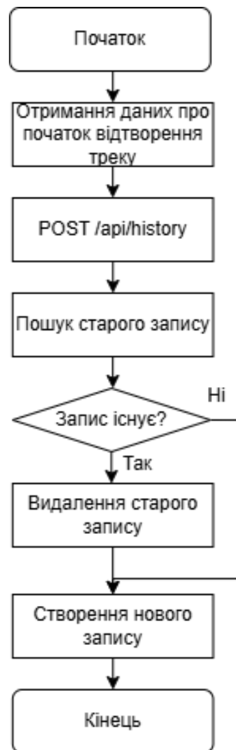
Рис. 3.5 Блок-схема алгоритму запису історії
