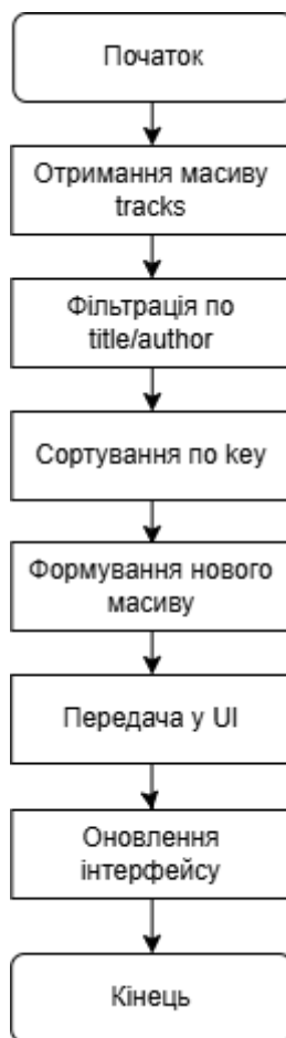
Рис. 3.7 Блок-схема алгоритму фільтрації та сортування
