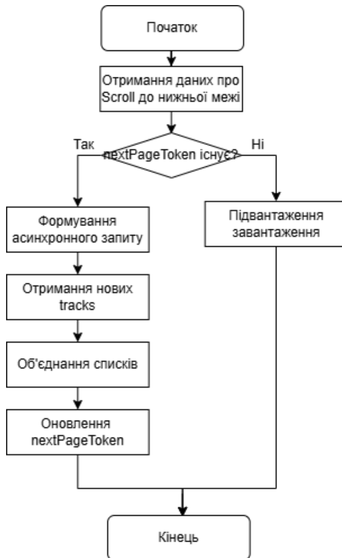
Рис. 3.9 Блок-схема алгоритму підвантаження треків
