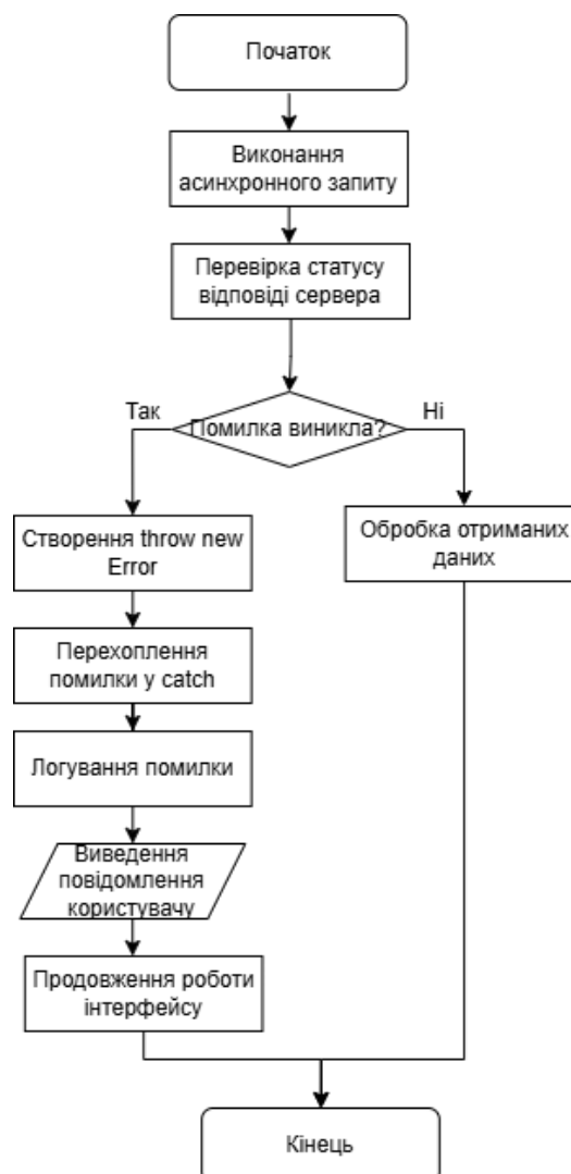
Рис. 3.10 Блок-схема алгоритму обробки помилок
