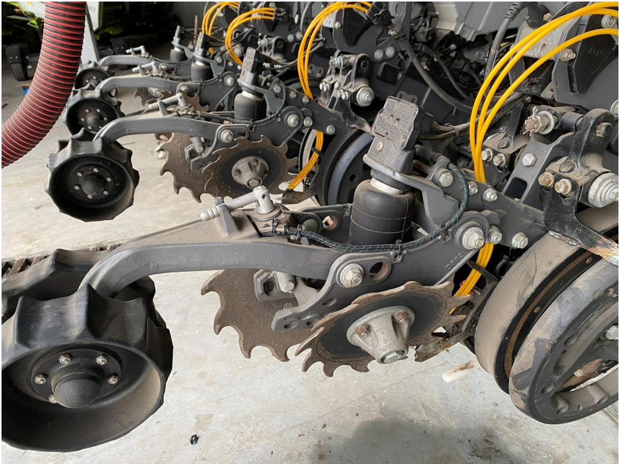
Рис. 1.8. Двоступенева закриваюча система Furrow Force
