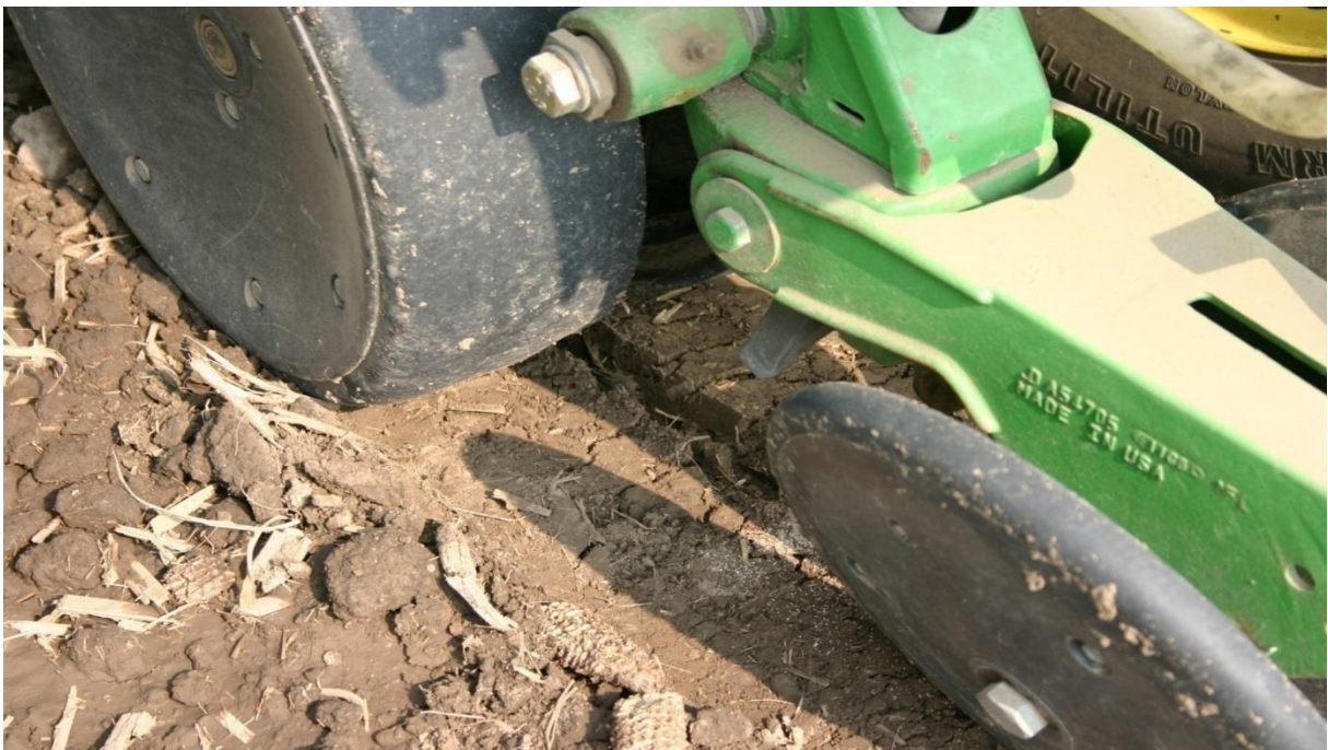
Рис. 1.2. Переущільнення ґрунту під час проходження сівалки
