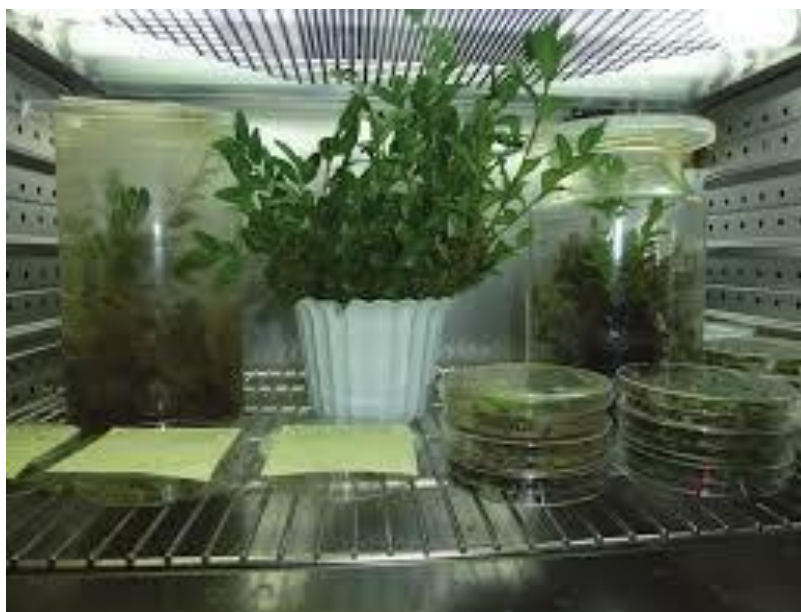
Рис. 1.9. Кліматична камера для вирощування біологічного матеріалу
