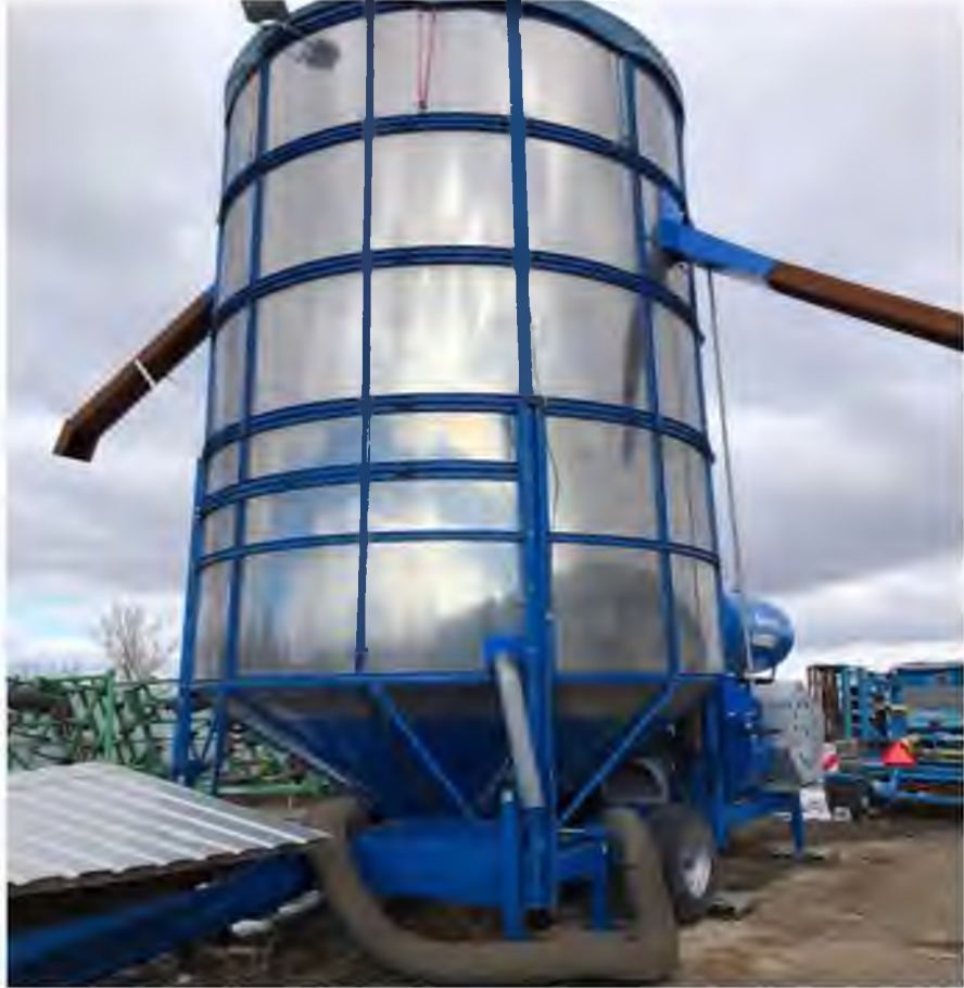
Рис. 2.7. Загальний вигляд сушарки ZAFFRANI 310 GZ у «ПП Спрінг-К»
