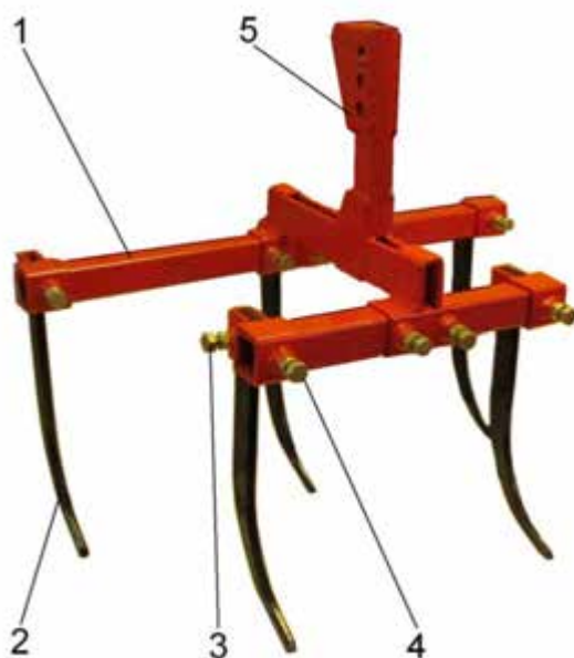
Рис. 2.15. Рама навісна універсальна «Мотор Січ РНУ–1В» із долотоподібними розпушувальними лапами
