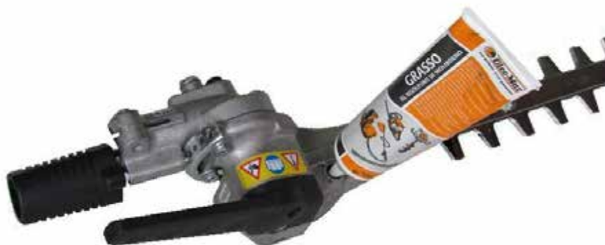
Рис. 4.3. Мащення корпуса передачі ріжучого інструмента мастилом трансмісійним
