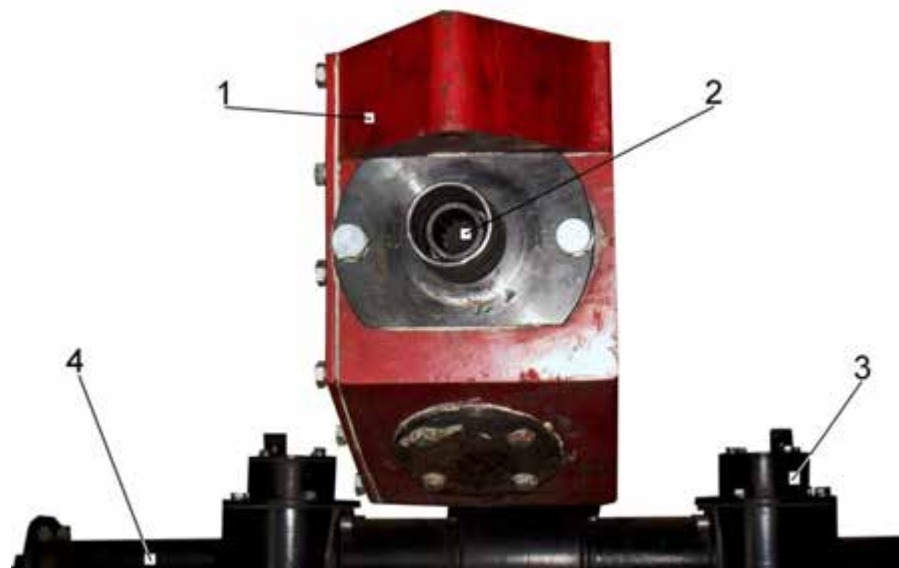
Рис. 3.12. Механізм з'єднувальний косарки роторної «Мотор Січ КРН-1С»
