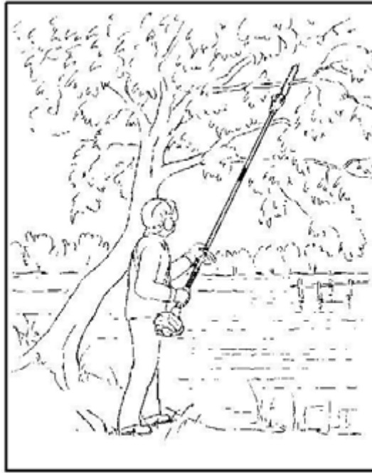
Рис. 5.20. Зрізання гілок над перешкодою висоторізом із подовженим штоком
