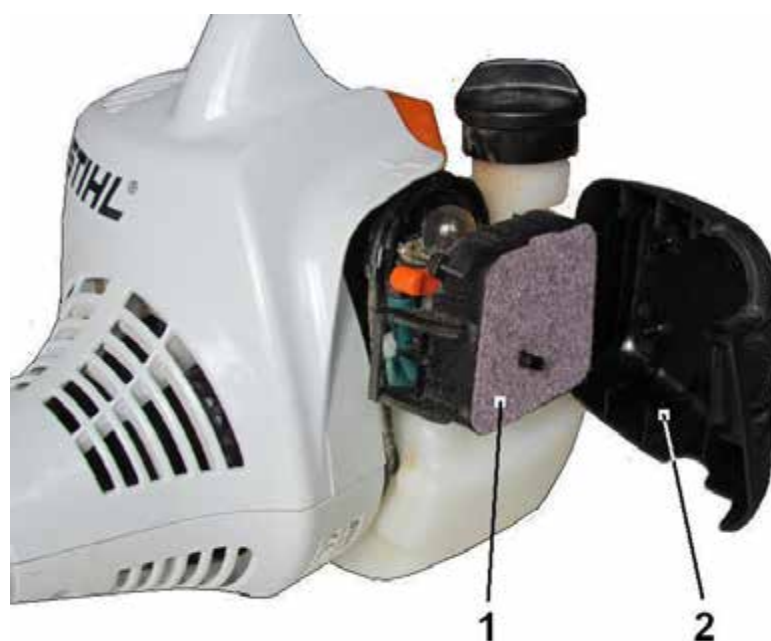
Рис. 2.14. Установка фільтра повітряного в корпус після чистки
