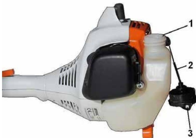
Рис. 2.5. Підготовка двигуна до заправки паливною сумішшю
