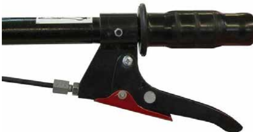
Рис. 4.10. Важіль керування муфтою зчеплення (зчеплення увімкнено)
