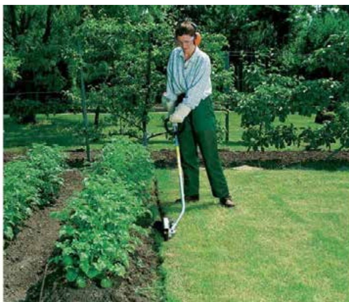
Рис. 6.10. Кромкоріз на підрізанні країв газону
