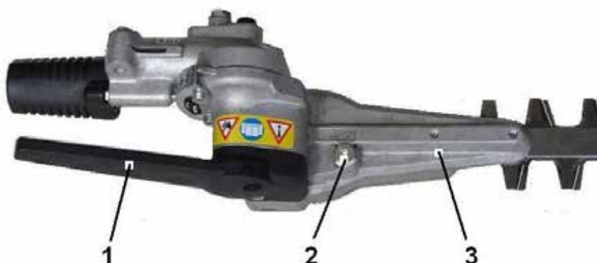
Рис. 4.2. Місце мащення передачі ріжучого ножа
