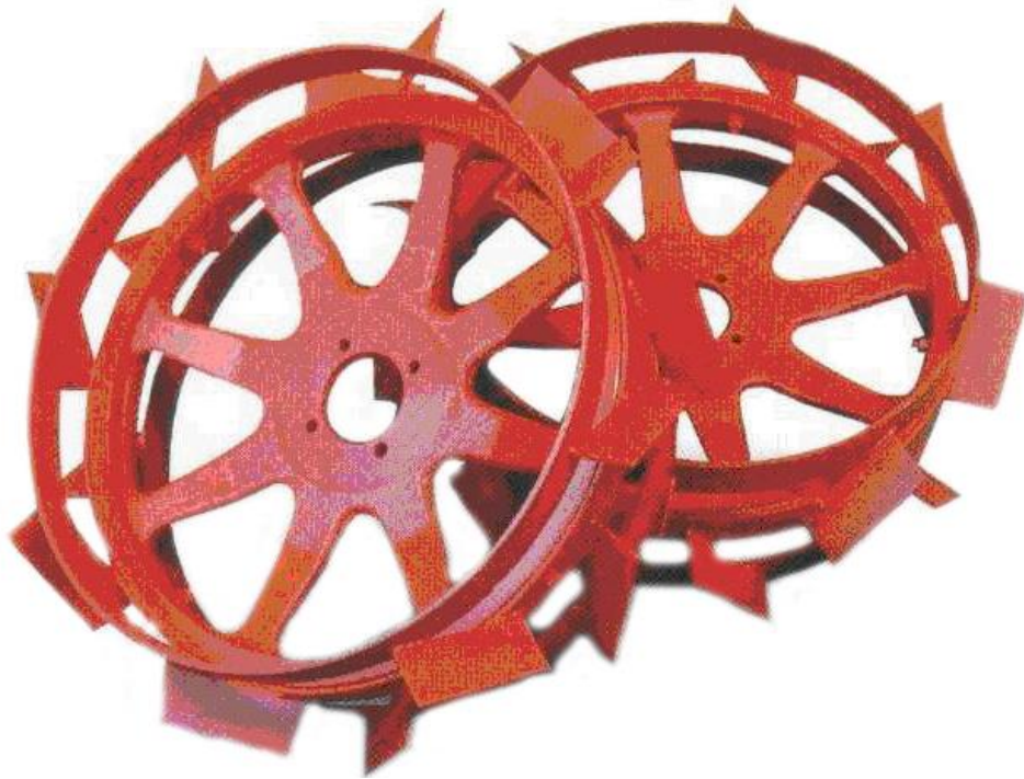
Рис. 2.9. Металеві колеса із ґрунтозачіпами з набору для землеорних робіт
