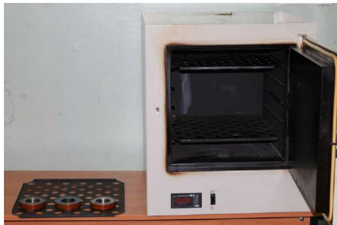
Рис. 3.5. Шафа СНОЛ-3.5,3.5,3.5/3 для сушіння деталей після нанесення покриття
