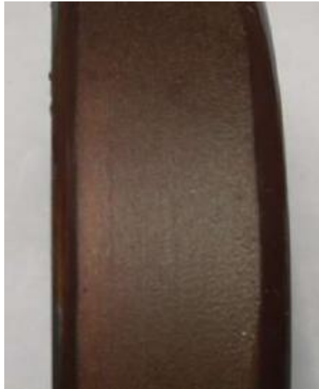
Рис. 4.7. Покриття полімерне з еластомеру після обробки фрезою ВК-8 при частоті обертання n = 2000 \text{ хв}^{-1} і подачі S = 0,02 \text{ мм/об} .
