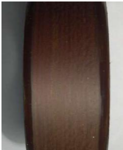
Рис. 4.6. Покриття полімерне з еластомеру після обробки фрезою ВК-8 при частоті обертання n = 2000 \text{ хв}^{-1} і подачі S = 0,05 \text{ мм/об} .
