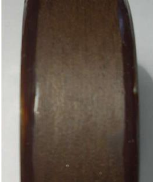
Рис. 4.5. Покриття з полімеру після обробки фрезою ВК-8 при частоті обертання n = 2000 \text{ хв}^{-1} і подачі S = 0,08 \text{ мм/об} .
