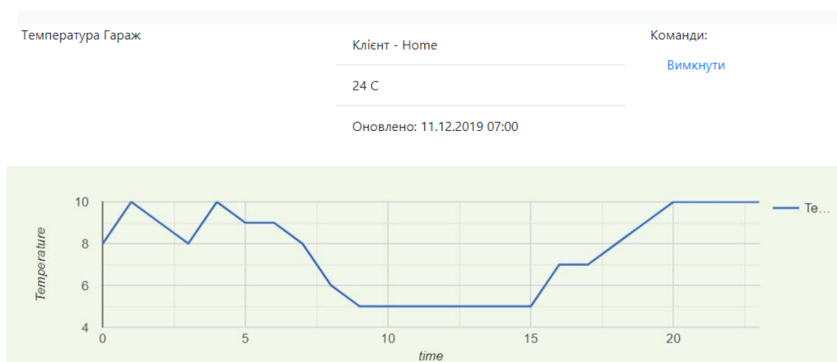
Рис. 3.12. Детальна інформація про пристрій та графік зміни температури
