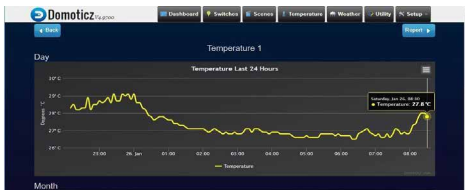
Рис. 2.14. Графік зміни температури у датчика DS18B20
